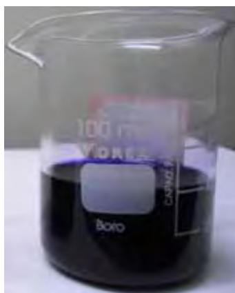
Figura 22 - Solução precursora preparada para realizar a impressão da trilha.
