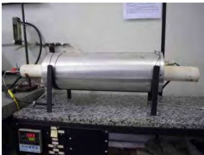
Figura 28 - Forno tipo túnel para sinterizar as trilhas impressas.
