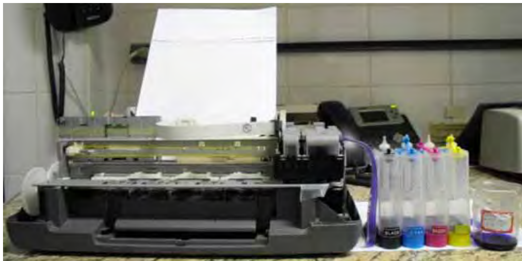
Figura 26 - Esquema para impressão direta de uma trilha supercondutora com impressora. À direita vê-se o reservatório bulk-ink ligado aos cartuchos e o Becker com a solução precursora.
