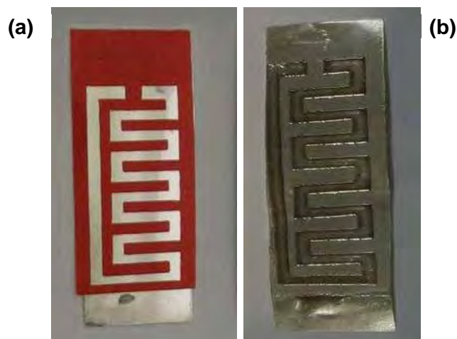
Figura 16 - Trilha supercondutora produzida por adesivos, em (a) tem o adesivo sobre o substrato e em (b) a trilha depositada sobre o substrato. [5]
