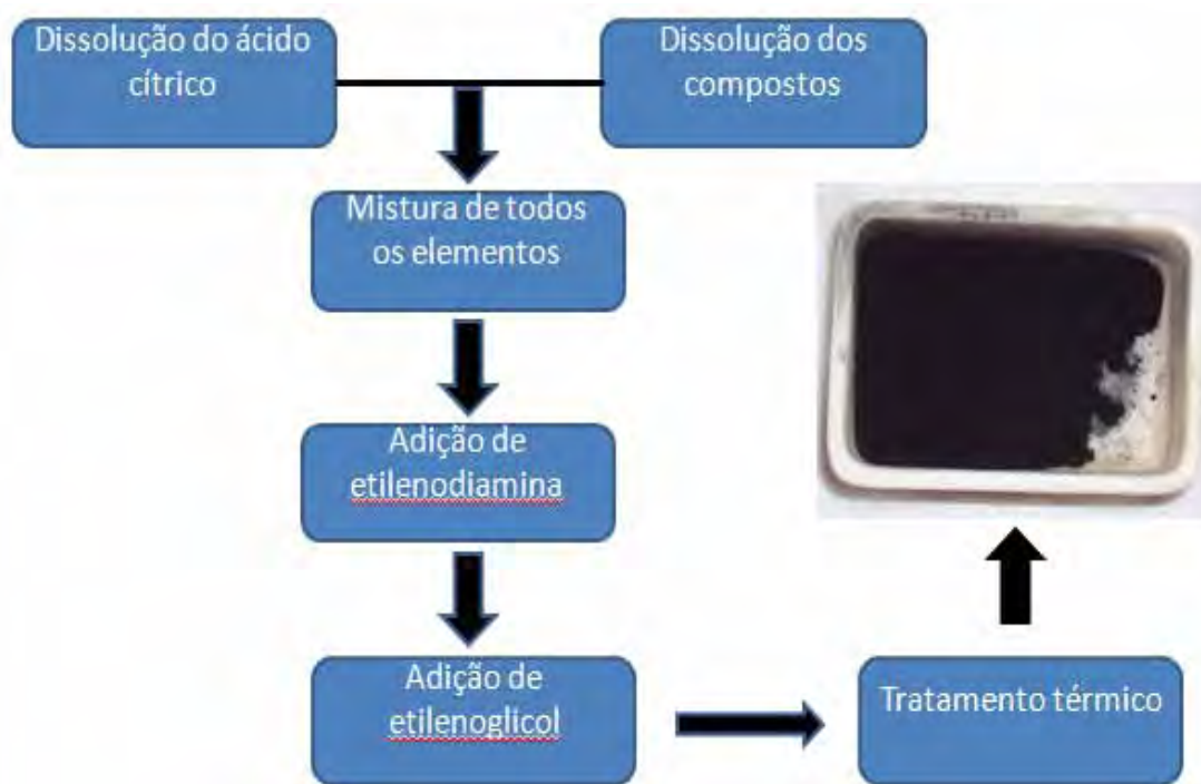
Figura 10: Diagrama esquemático para o processo de preparação da solução precursora.
