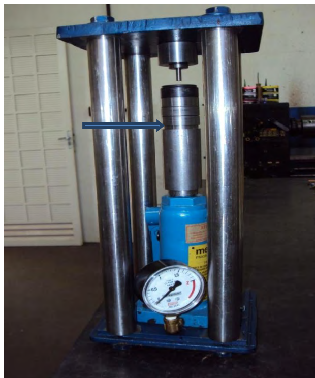
Figura 18: Montagem completa do sistema utilizada para o processo de extrusão do fio.
