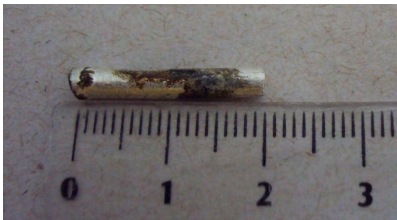
Figura 19: Foto de um fio supercondutor sinterizado a 835°C/10h.
