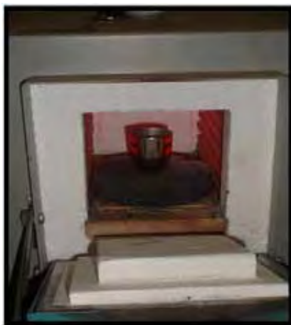
FIGURA 15: Forno de obtenção da amostra, inserido o grafite
