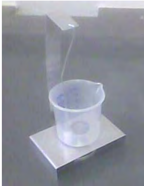
Figura 8 – Montagem dos aparatos para a determinação da densidade das amostras.
