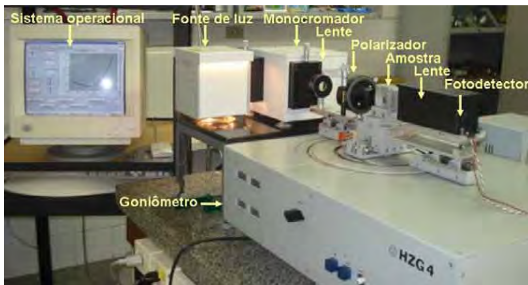
Figura 32 – Sistema utilizado para determinação do índice de refração pelo método de Brewster
