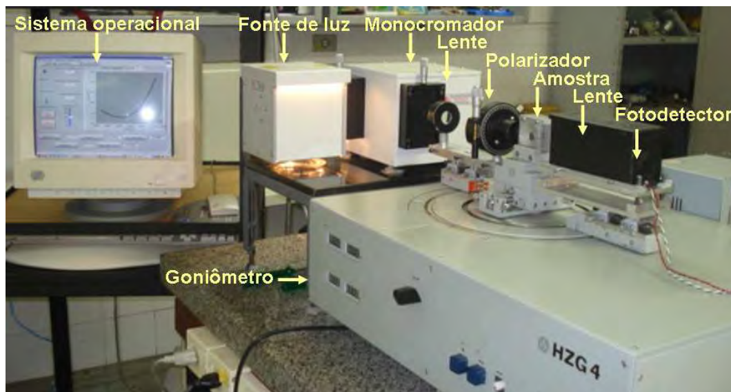
Figura 22. Fotografia do sistema utilizado para determinação do índice de refração pelo método de Brewster.
