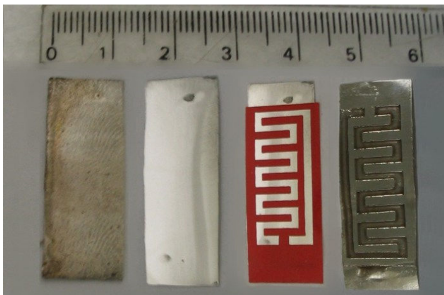
Figura 20 - Processo de preparação do circuito supercondutor.
