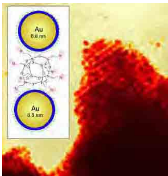
Figura 4: Imagem TEM de cubo de silsesquioxano e aglomerados de 1,2 a 6,8nm de Au agregados por interações iônicas.
