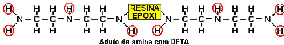
Figura 34. Esquema de um aduto de amina formado com moléculas do agente de cura DETA.
