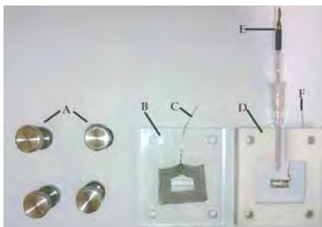
Figura 16. Célula espectroeletróquímica empregada nas medidas de XAS e suas respectivas partes em uma visão lateral. A) Parafusos e porcas de aço para fechar a célula. B) Parte em acrílico. C) Contra eletrodo de Pt. D) Separador de Teflon. E) Eletrodo de referência de hidrogênio. F) Contato da pastilha da amostra de catalisador [74].
