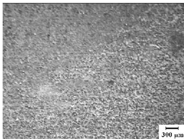
Figura 57. Imagens obtidas por MO do Galvannealed exposto à dicitlohexilamina por 50 dias na câmara úmida.
