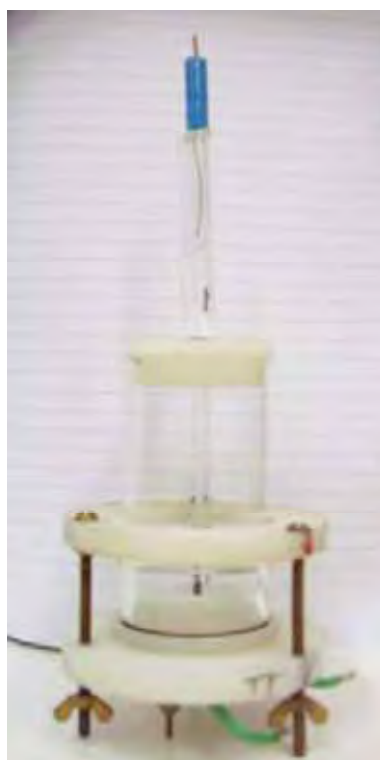
Figura 18. Imagem da célula eletroquímica utilizada para os ensaios de ENA.
