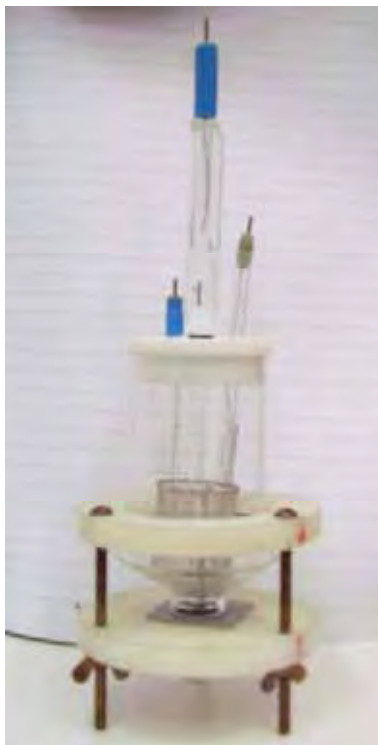
Figura 21. Imagem da célula eletroquímica utilizada nos ensaios de EIS.
