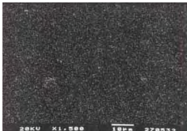
Figura 23. Mapeamento do ferro obtido por MEV da superfície do Galvannealed.
