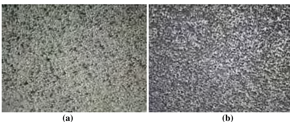
Figura 85. Imagens obtidas por MO da amostra após 6 horas em NaCl 0,1 mol L -1 , pH 3, exposta por 1 dia ao BDi (a) e a amostra controle (b) na mesma condição.
