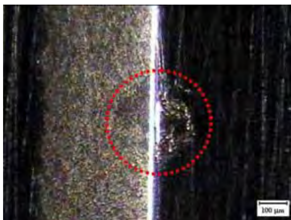
Figura 54. Micrografia da interfase cermet/aço SAE 1045 após os ensaios com a microcélula ( A_{\text{geom}} = 3,1 \times 10^{-4} \text{ cm}^2 ).
