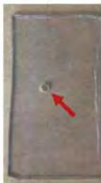
Figura 12. Fotografia do substrato que será preparado para atuar como contra-eletrodo. Em destaque, o orifício que será posteriormente utilizado para a injeção do eletrólito.
