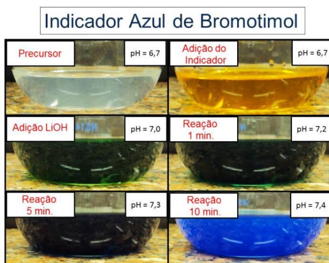
Figura 3.22 - Evolução das cores na suspensão de ZnO em função do tempo de reação na presença de indicador ácido-base.
