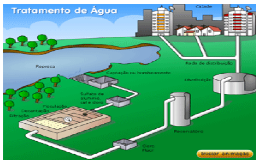
Figura 5: Esquema de tratamento da água
