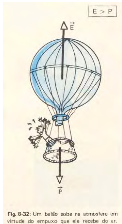
Figura 1 – Esquema ilustrando as forças peso e empuxo em um bloco genérico Figura 2 - Representação das forças peso e empuxo em um balão subindo
