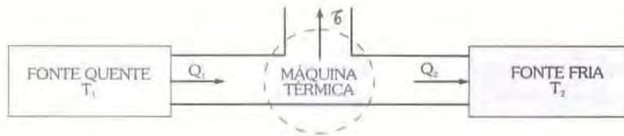
Figura 8 - Diagrama para o funcionamento de uma máquina térmica
