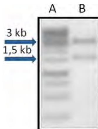
Figura 17 - Análise da digestão com a enzima EcoRI de um dos clones recombinantes obtidos no vetor pGEM-Teasy (3 kb). A - Ladder 1 kb. B - Clone recombinante contendo o fragmento promotor do candidato com expressão específica em folha (1,5 kb). As setas indicam as bandas de 1500 e 3000 pb. Os produtos foram visualizados em gel de agarose 1% corado com brometo de etídeo.
