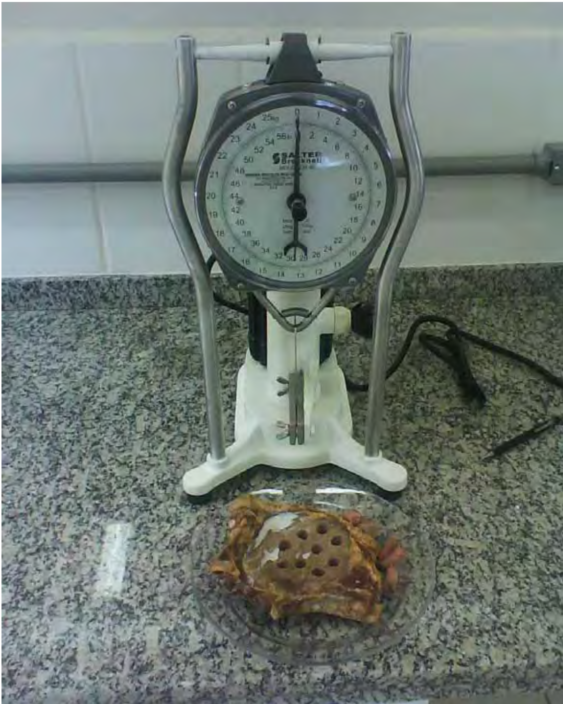
Figura 3: Warner-Bratzler e amostra com cilindros para realização da maciez
