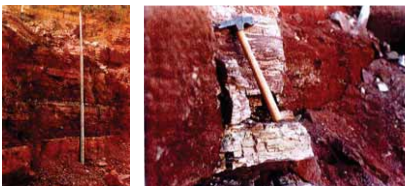
Figura 15: Frente da lavra da Mina Tutte e sucessão de siltitos e argilitos em afloramento da Formação Corumbataí (BONINI, 2004)
