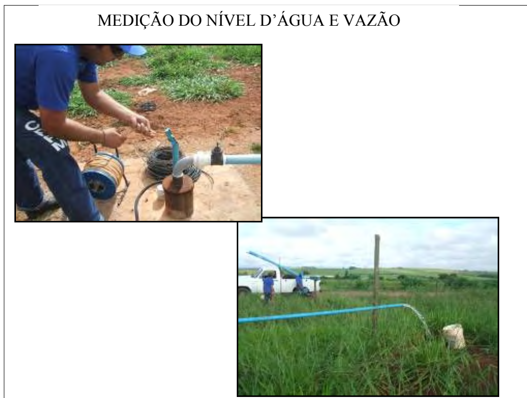
Figura 8– Medição do nível d'água e vazão durante os testes de bombeamento
