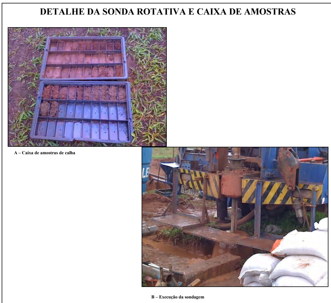
Figura 4 - Detalhes das caixas de amostras (A), e da execução da sondagem (B)
