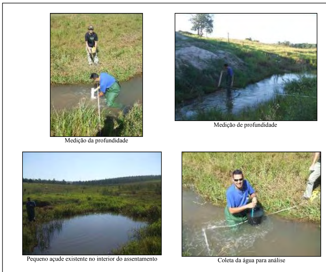
Figura 10 – Coleta de água superficial, medições de largura e profundidade dos corpos de água superficiais
