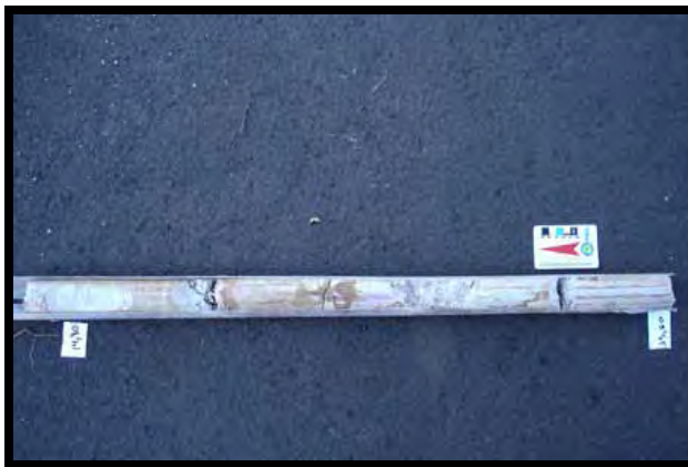
Foto 5 - Liner contendo amostra de rocha, recuperada pelo Geoprobe.
