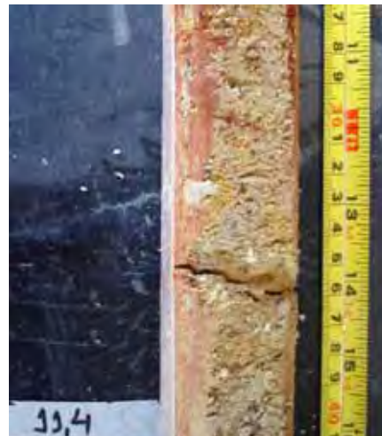
Foto 10 – Arenito muito argiloso. Amostra recuperada do poço PM-27, à profundidade de 11,4 m.
