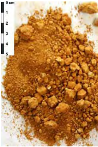
Foto 7 – Silte argiloso. Amostra recuperada do poço PM-28 a profundidade de 10 m.
