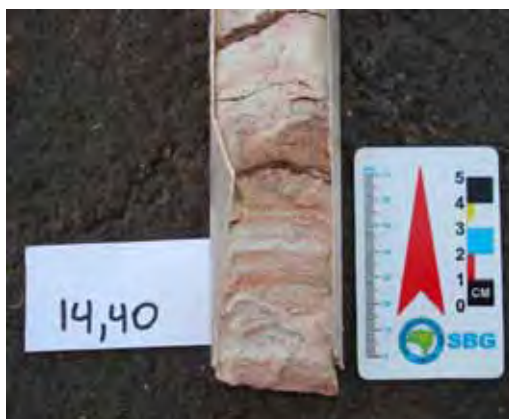
Foto 14 – Areia média a grossa em contato erosivo com siltitos argilosos. Amostra recuperada do Poço PM-41, à profundidade de 13,90 m.
