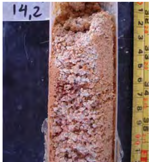
Foto 12 – Areia média a grossa. Amostra recuperada do poço PM-43, à profundidade de 14,2 m.
