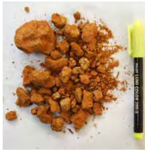
Foto 8 – Clastos de siltitos laterizados, dispersos em uma matriz silto-argilosa. Amostra recuperada do PM 29 a profundidade de 12 m.
