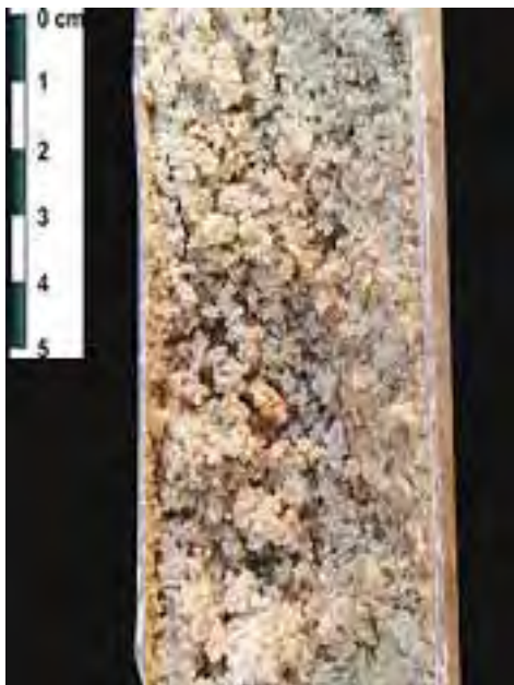
Foto 11 – Areia média a grossa. Amostra recuperada do poço PM-26, à profundidade de 13,5 m.
