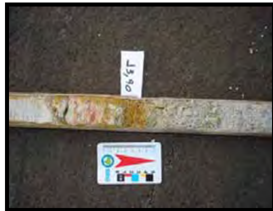
Foto 6 – Detalhe da amostra de rocha recuperada pelo Geoprobe.
