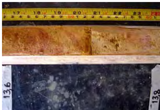
Foto 13 – Areia média a grossa argilosa. Amostra recuperada
