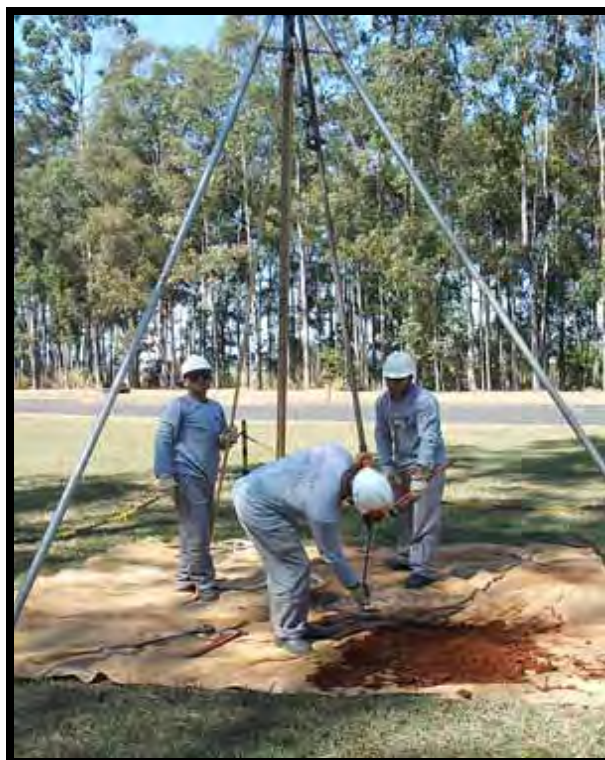
Foto 2 – Perfuração de sondagens por meio de trado manual.
