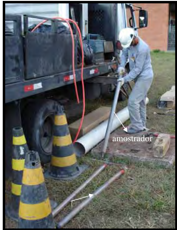
Foto 4 – Detalhe do amostrador do Geoprobe e liners contendo amostras recuperadas.
