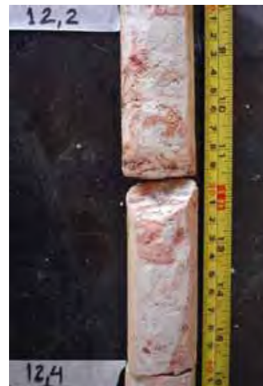
Foto 15 – Silito maciço róseo. Amostra recuperada do Poço PM-46, à profundidade de 12,4 m.
