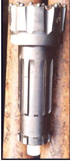
Foto 3a: Vista lateral do Bit de Perfuração
