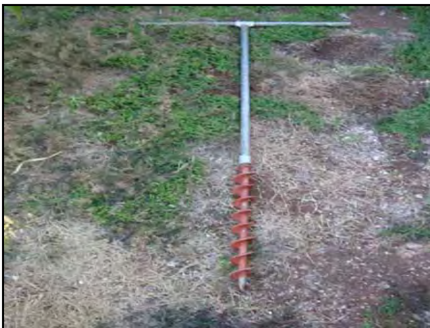
Figura 21 – Trado Helicoidal de 2” utilizado para perfurar nas amostragem de 4,00 m.
