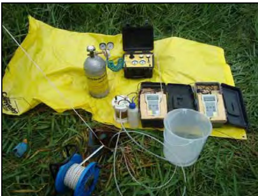
Figura 23 – Técnica de baixa vazão para amostragem de água subterrânea.
