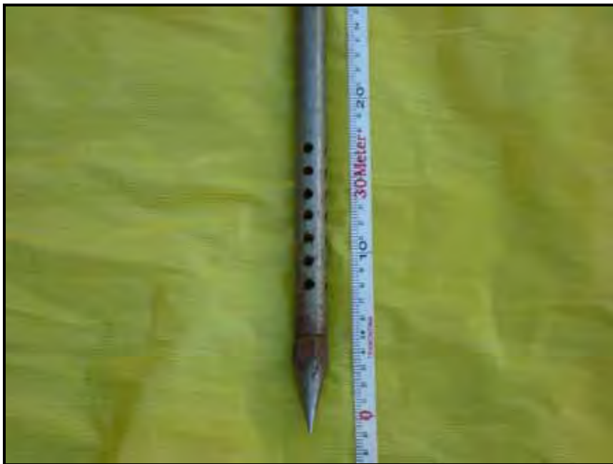
Figura 18 – Detalhe da sonda amostradora.
