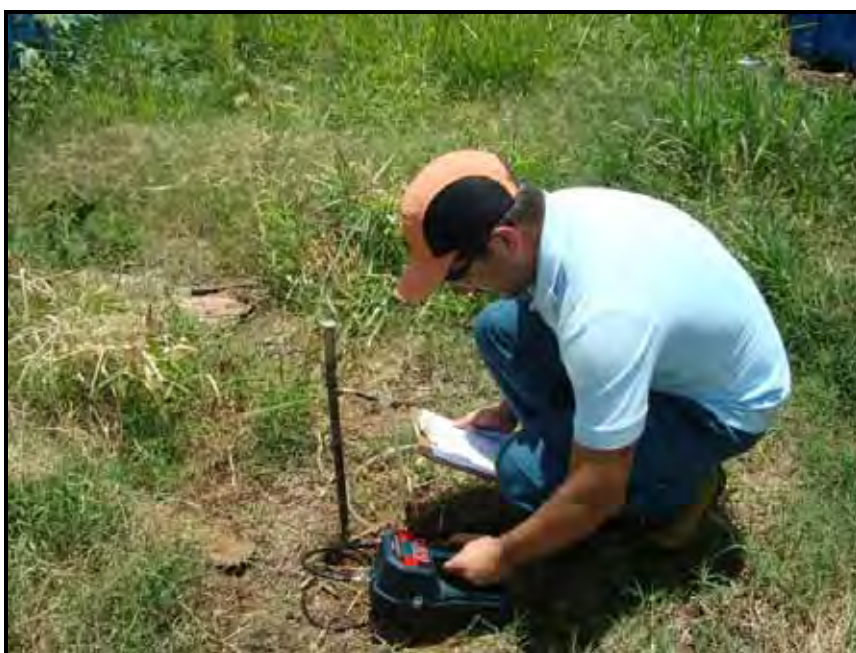
Figura 20 – Leituras dos vapores com analisador Thermo Gastech , modelo Innova SV .
