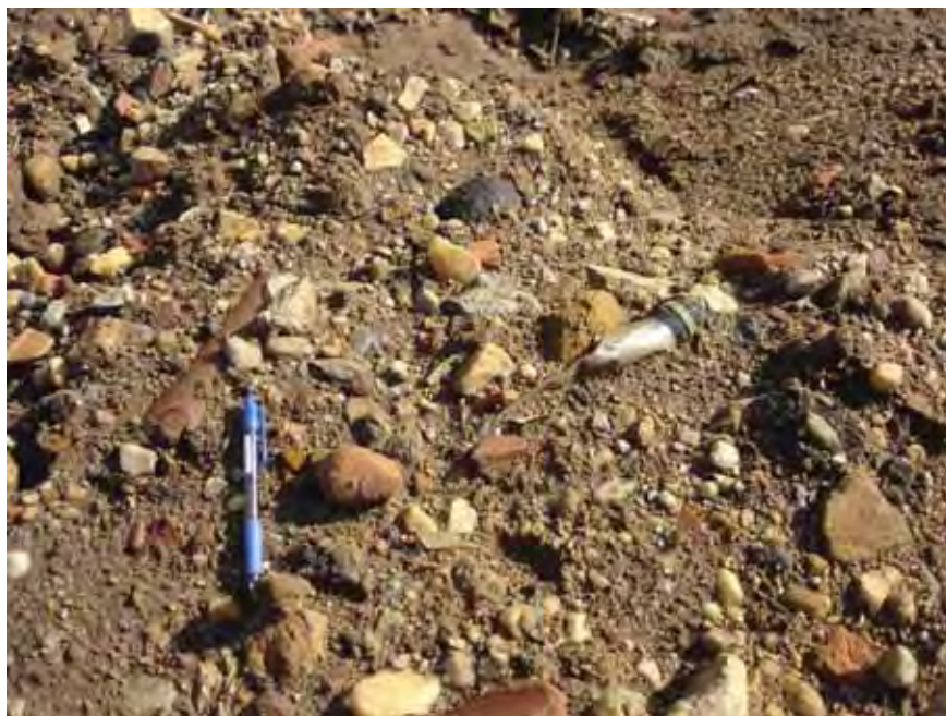
Figura 46. Material constituinte do dique marginal artificial. Margem direita do ribeirão Anicuns, Goiânia - Goiás.
