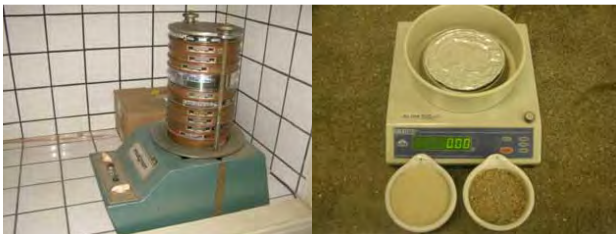
Figura 7 – Conjunto de peneiras no agitador (à esquerda) e balança de bancada de precisão com exemplos de amostras de areia fina (esquerda) e areia grossa mista (direita).
