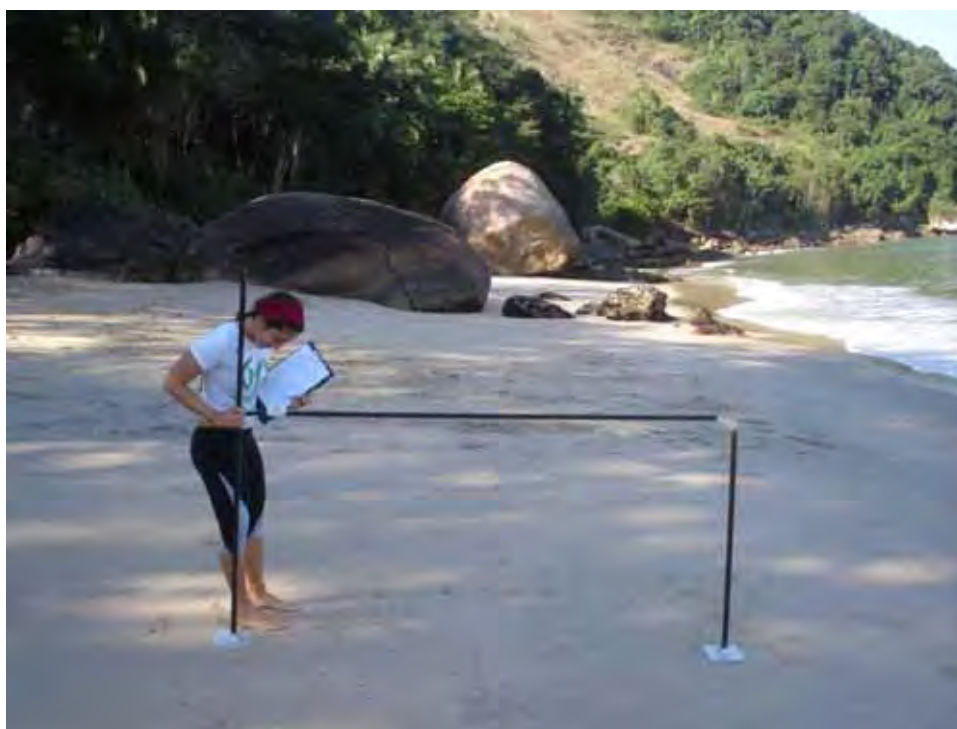
Figura 5 - Medição de perfil topográfico de praia com uso do declivímetro.
