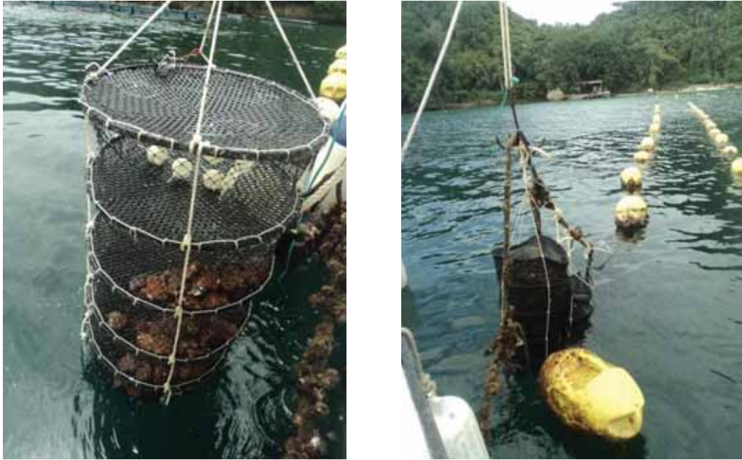
Figura 08. Imersão das vieiras e dispositivos DGT em um ponto de amostragem. Observar a utilização de lanternas para a acomodação dos animais e dispositivos.
