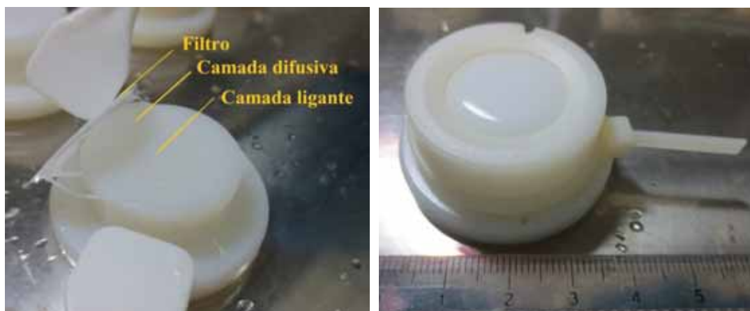
Figura 06. Montagem do dispositivo DGT. Observar as camadas de géis - ligante e difusivo - e o filtro protetor (esquerda). Dispositivo DGT montado e identificado, pronto para ser utilizado in situ (direita).
