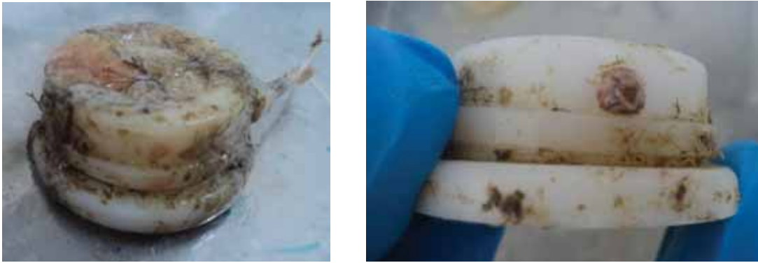
Figura 15. Dispositivos DGTs imersos durante 60 dias na Baía da Ilha Grande, RJ. (a) Presença de uma extensa camada de algas formando sobre a janela de exposição (esquerda). Incrustação de uma craca na lateral do dispositivo (direita).
