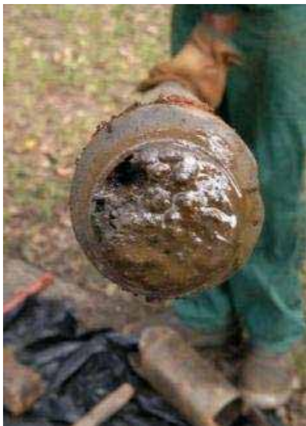
Figura 54. Amostra de solo com iridescência – sondagem ao lado poço PZ-02A.
