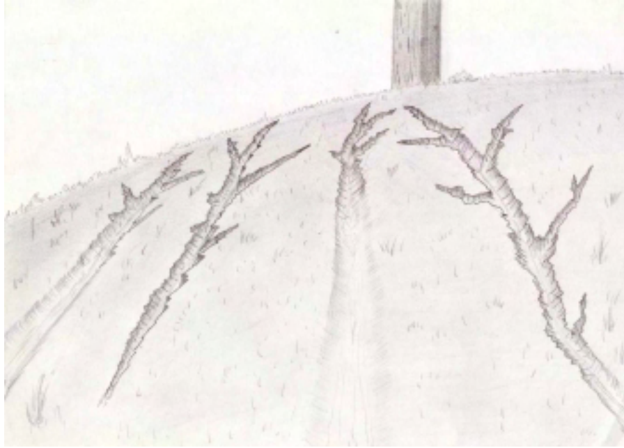
FIGURA 3 – Feições erosivas de pequeno porte, sulcos e calhas.
