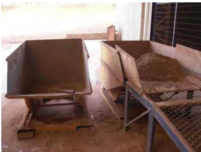
Figura 29 - Caçamba de argila no setor de moagem de argila.
