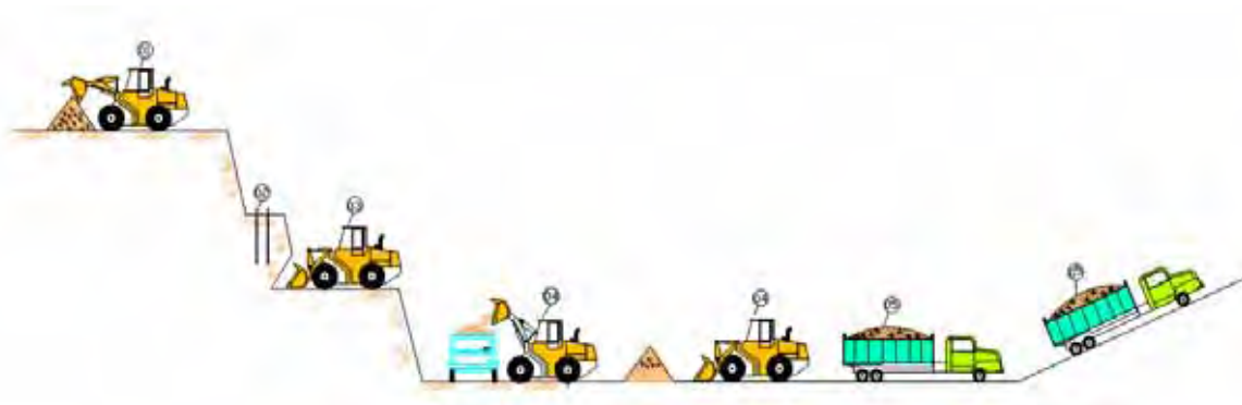
Figura 5 - Processo de extração da matéria-prima. 01-Limpeza; 02-Detonação; 03- Extração Mecanizada; 04-Carregamento; 05-Transporte (Autor: Cerâmica Carmelo Fior Ltda).
