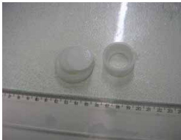
Figura 5: Pistão e tampa plástica usados no dispositivo da técnica DGT.
