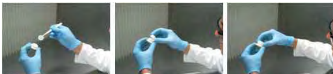
Figura 10: Montagem do Sistema DGT
