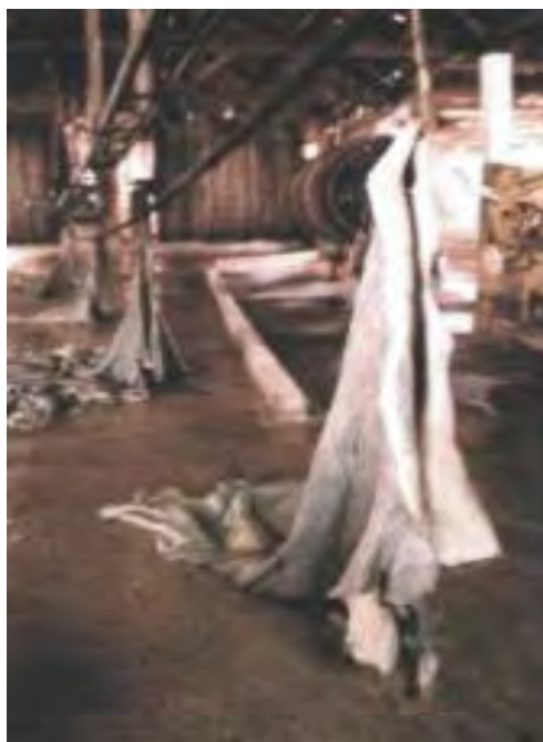
Foto 2 - ganchos de transporte - Curtume Touro Peles saindo dos fulões após as primeiras etapas para a próxima fase.
