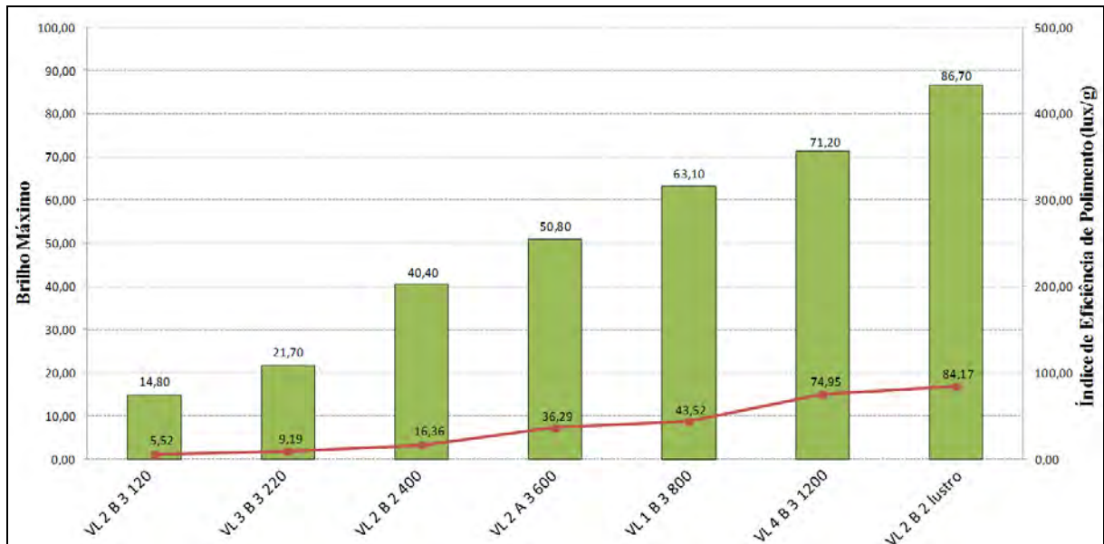
Figura 99. Correlação dos melhores brilhos com o Índice de Eficiência de polimento no charnoquito Verde Labrador.
