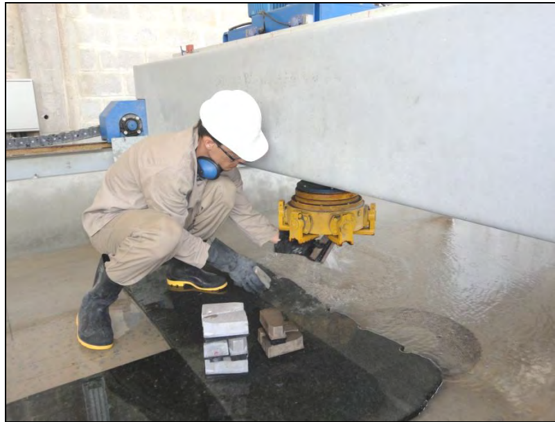
Figura 41. Substituição dos abrasivos.
