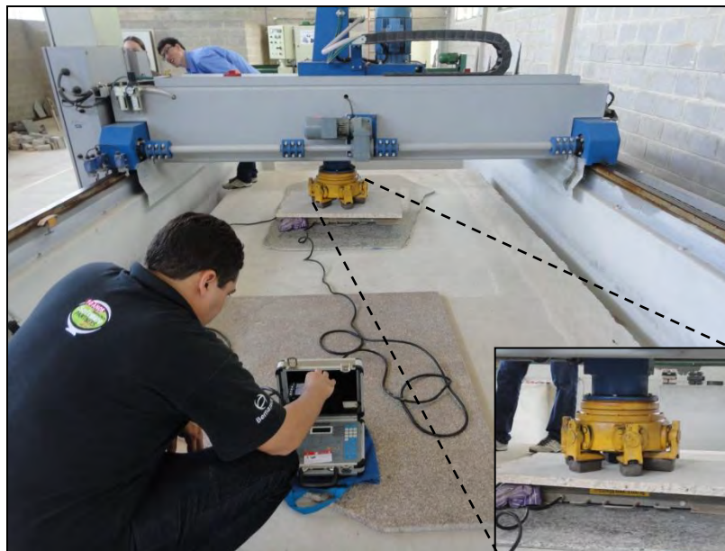
Figura 31. Procedimento de calibração das pressões de carregamento.
