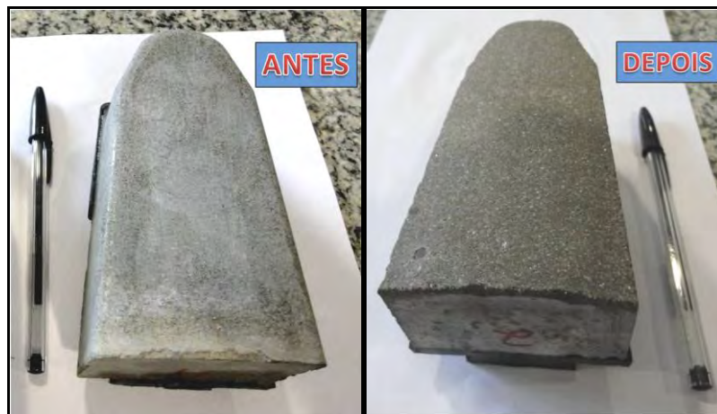
Figura 37. Abrasivo 60 mesh antes e depois de ser afiado.
