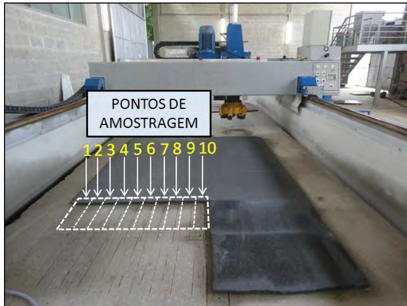
Figura 42. Demarcação dos pontos de amostragem de rocha em um ciclo de polimento.
