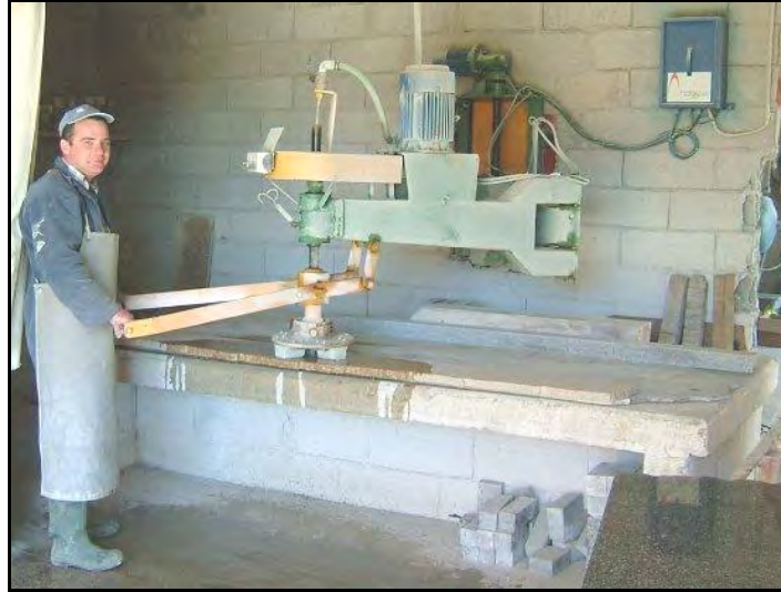
Figura 13. Modelo de poltriz manual constituída de um braço móvel, no qual em sua extremidade tem um cabeçote onde são fixados os rebolos abrasivos.
