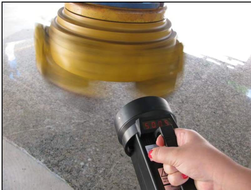
Figura 33. Medição da velocidade de rotação de satélite de uma politriz semi-automática.
