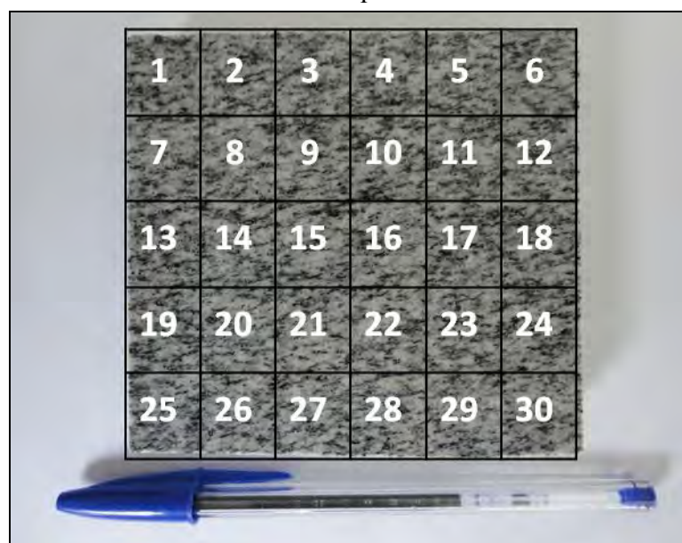
Figura 48. Amostra de rocha com esquema de leituras de brilho adotado.
