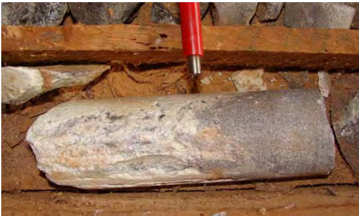
Foto 3. Testemunho de sondagem do furo FS-07, realizado na região da Mina Paca. Contato brusco entre o clorita-carbonato-talco xisto e nível de cromitito.
