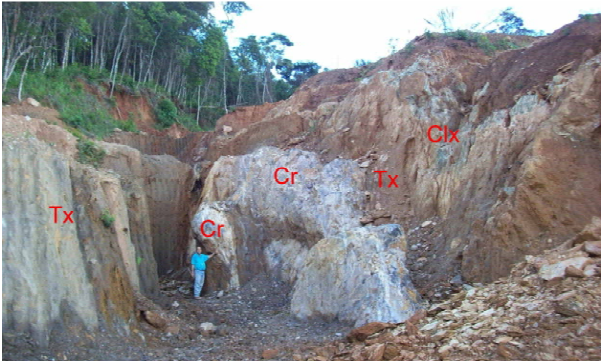
Foto 1. Visão geral da 6ª bancada da Mina Carijó. Nota-se a verticalização das camadas, e grande lente de cromitito maciço no centro da mina. (Cr - Cromitito, Tx - Clorita-carbonato-talco xisto, Clx - Talco-clorita xisto).
