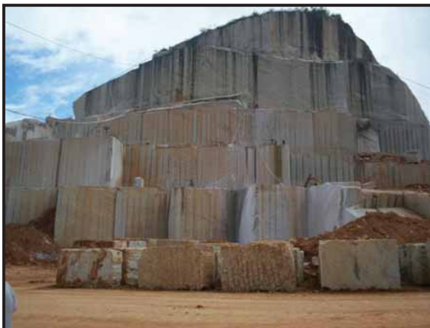
Figura 22. Lavra pelo método de bancadas altas. Barra de São Francisco – ES.
