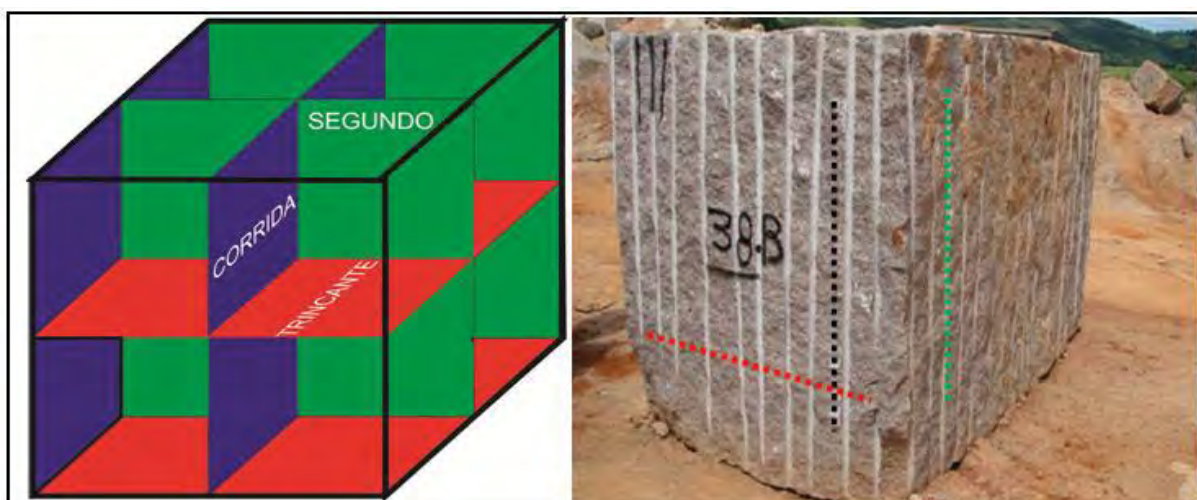
Figura 5. Sentido das lineações em relação às microfissuras de alívio
