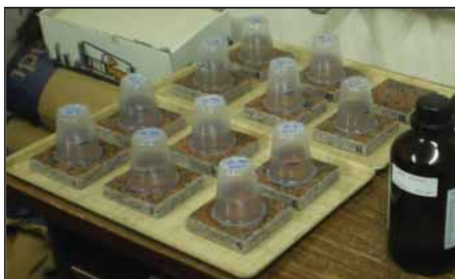
Figura 14. Ilustração do método de exposição da rocha aos reagentes
