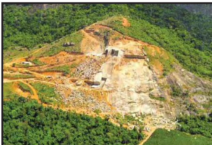
Figura 24 Lavra de capeado, por desabamento, do Granito Giallo Esperança, da Rocha Branca Mineração, Boa Esperança-ES.
