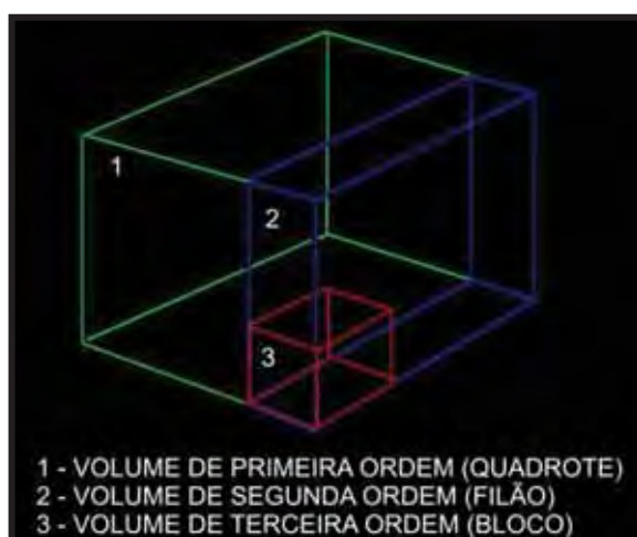
Figura 27. Esquema de divisão dos volumes extraídos em uma pedreira
