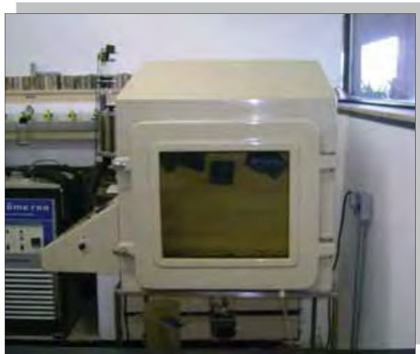
Figura 2.7. Câmara de exposição ao dióxido de enxofre (SO 2 ).
