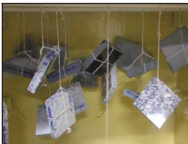
Figura 7.19. Corpos de prova das rochas estudadas no interior da câmara de exposição ao dióxido de enxofre.
