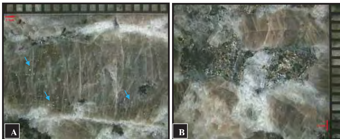
Figura 7.4. (A) Setas indicando pequenas pontuações esbranquiçadas provenientes da dissolução da apatita e (B) corrosão das biotitas.
