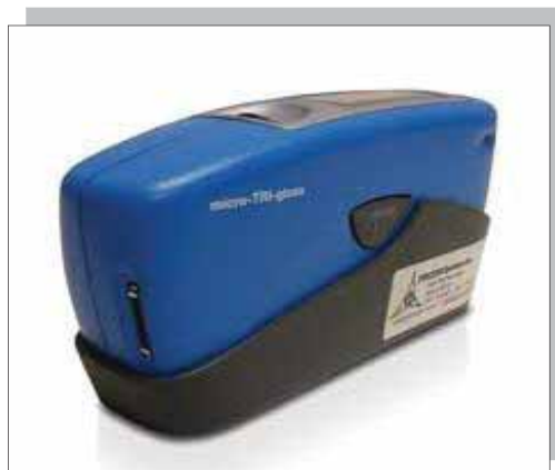
Figura 2.4. Gloss meter com sistema de medida de brilho em três ângulos.
