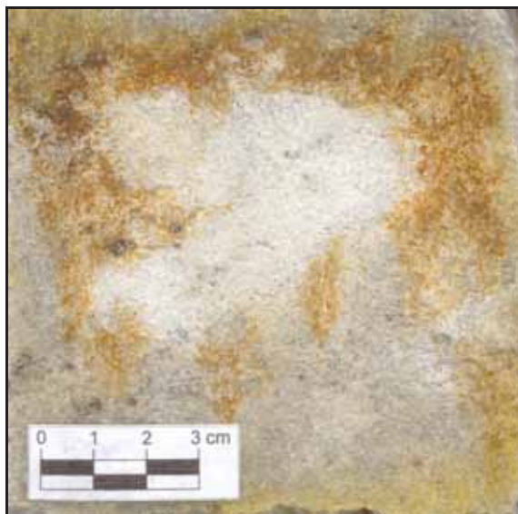
Figura 7.5. Tardoz da placa do material Branco Galaxy atacado com ácido clorídrico.
