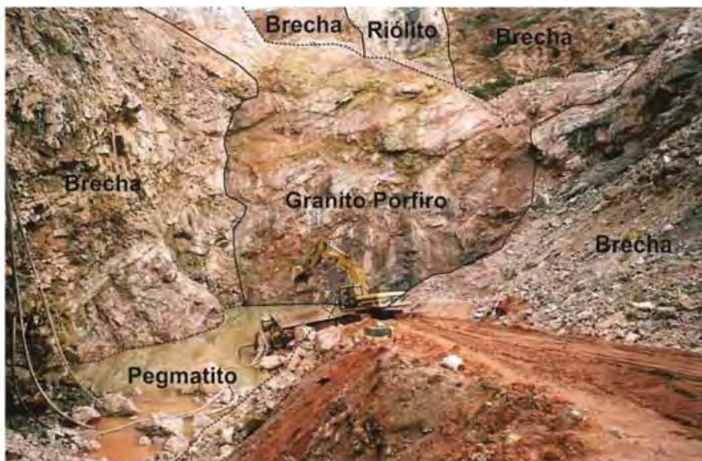
Foto 9: Vista geral da cava Cascavel, tomada de norte para sul. Em primeiro plano tem-se a bancada inferior, com pegmatito principal não visível (abaixo da lâmina de água) e brecha de pipe nas paredes da cava. Ao fundo, “muro” de topázio granito, bancada superior (seção de estudo) e dique de topázio riólito.
