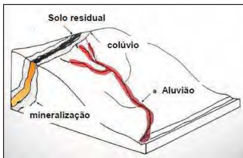
Figura 14: Figura ilustrando a destruição supergênica de um depósito mineral formando zonas de alteração (em vermelho) enriquecidas ou empobrecidas em vários elementos químicos relacionados a mineralização (Adaptado de Licht, 1998).
