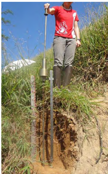
Figura 26 – Ensaio de DCP realizado na lateral do talude 1.
