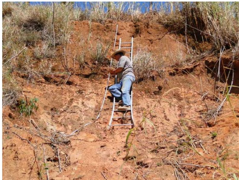
Figura 61 – Coleta de amostras deformadas no perfil de solo estudado – Talude 2.
