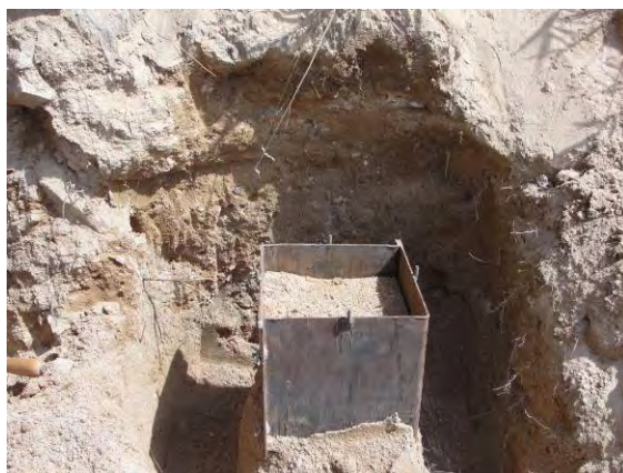
Figura 34 – Bloco de amostra indeformada sendo extraído na superfície de ruptura (talude 1).
