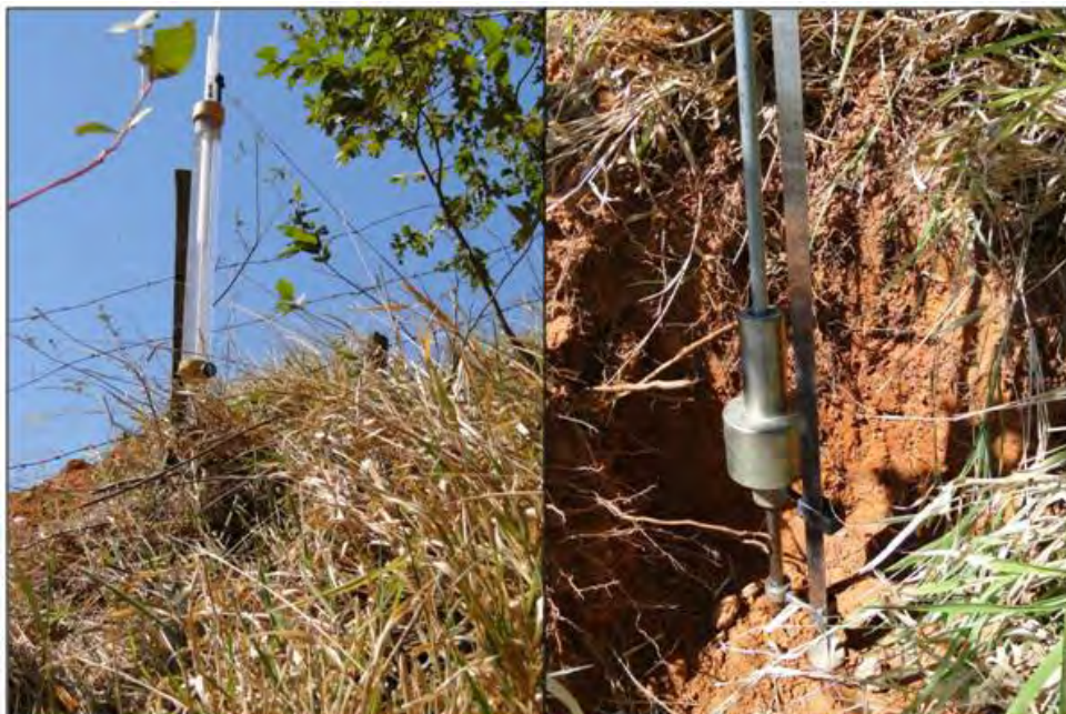
Figura 57 – Ensaios com Guelph e DCP no talude 2.
