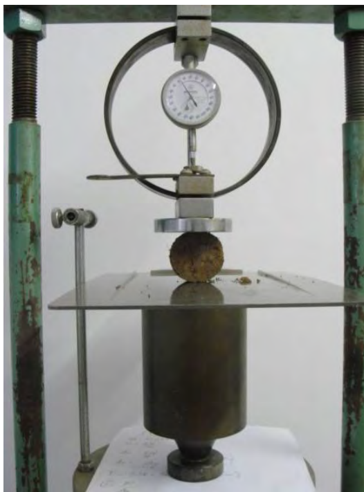
Figura 30 – Equipamento utilizado no ensaio de resistência à tração.
