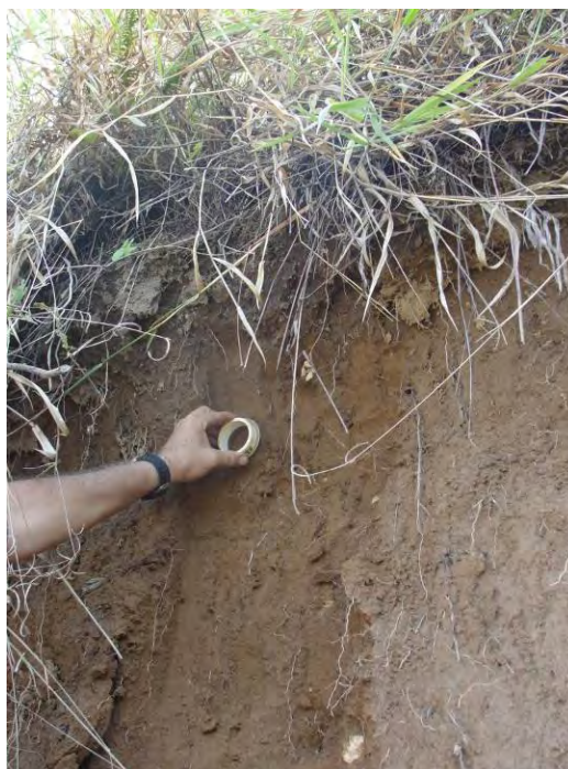
Figura 45 – Extração dos anéis para o ensaio de sucção.
