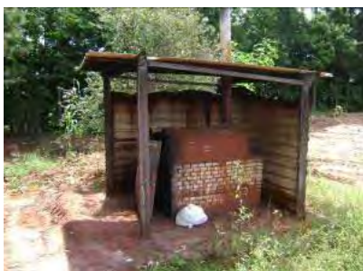
Figura 19 – Forno onde são queimados os RSS de Arealva.
