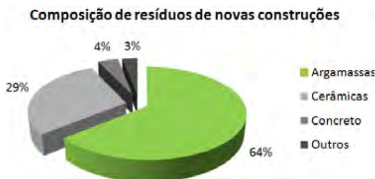
Figura 9: Composição de resíduos de novas construções, em massa (%). Fonte: Adaptado de Pinto (1986).
