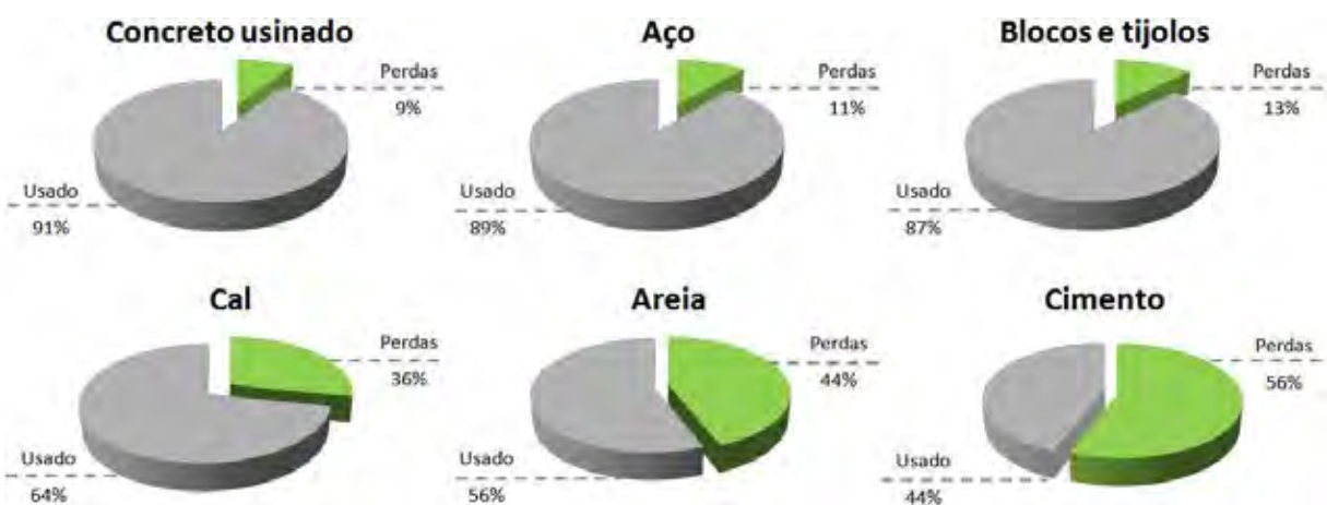
Figura 8: Perdas de materiais nos processos construtivos convencionais.
