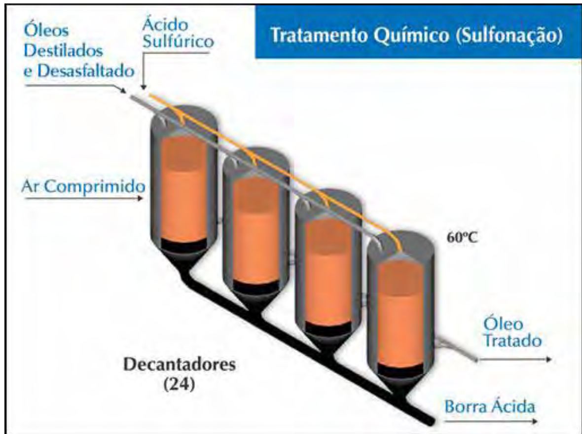
Figura 38 – Ilustração da etapa de Tratamento Químico
