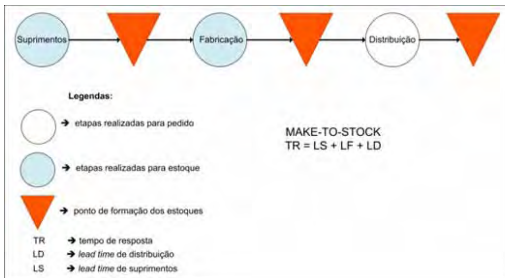
Figura 19: Fluxo do processo Make-To-Stock da empresa
