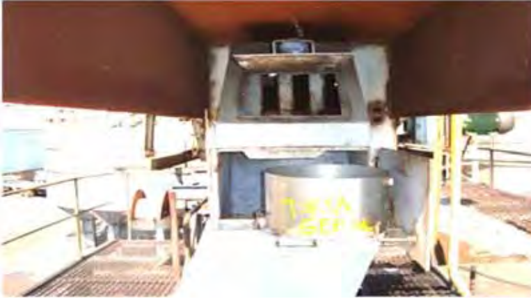
Figura 23 - Fotografia do amostrador e do ponto da amostragem composta da torta Fonte: Usina (2008).
