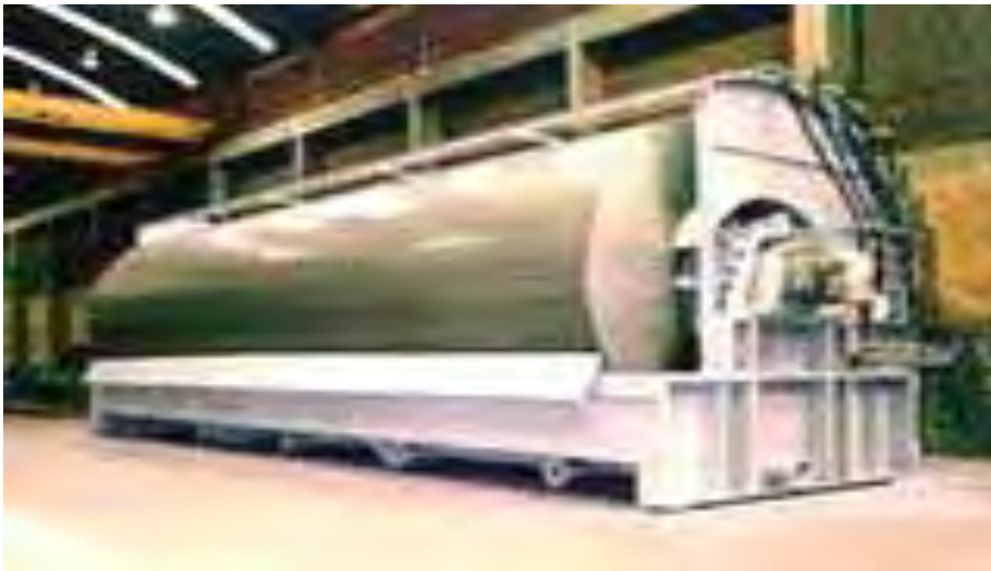
Figura 13 - Fotografia de um filtro de tambor rotativo contínuo a vácuo com dimensões de 4.270 mm diâmetro por x 12.190 mm de comprimento.
