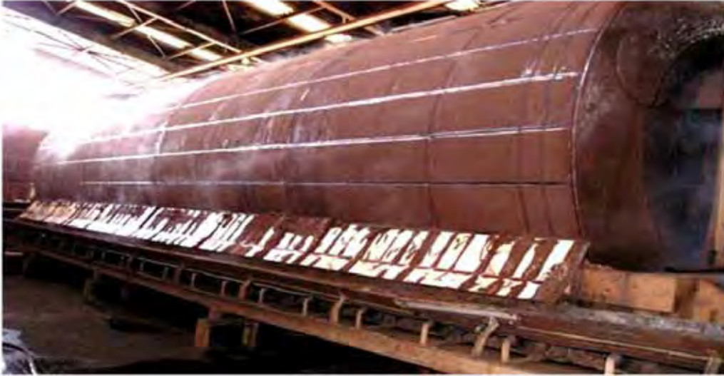
Figura 19 - Fotografia de um filtro contínuo de tambor rotativo a vácuo tamanho 4.270 mm de diâmetro por x 12.190 mm de comprimento (14'x 40') Mausa. Fonte: Usina (2008).
