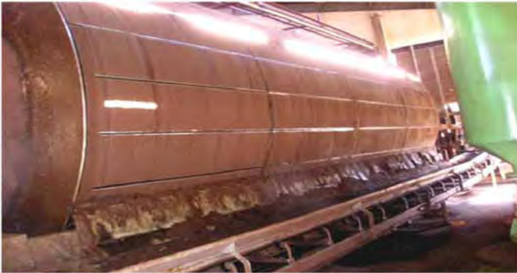
Figura 18 - Fotografia de filtro de tambor rotativo contínuo a vácuo com dimensões de 3.960 mm de diâmetro por x 7.930 mm de comprimento (13'x 26'). Fonte: Usina (2008).
