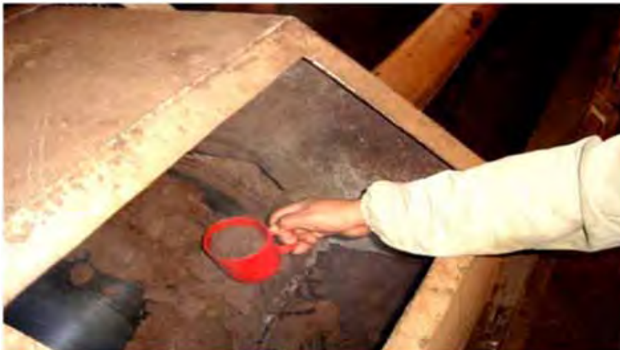
Figura 22 - Fotografia da forma e ponto da amostragem individual da torta de cada filtro Fonte: Usina (2008).
