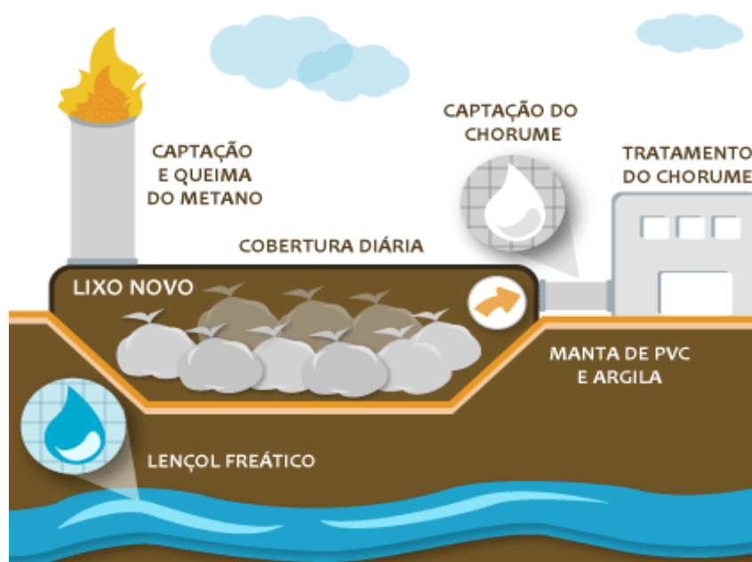
Figura 5 - Esquema da disposição dos resíduos sólidos em forma de um aterro sanitário.
