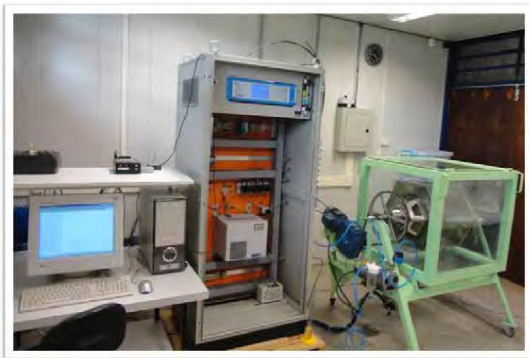
Figura 22 - Estrutura do processo de experimentos de compostagem formada basicamente por: tambor rotativo, analisador de gases e aquisição de dados.
