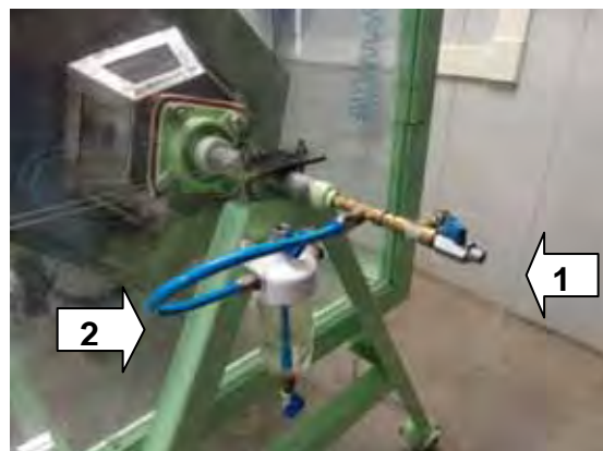
Figura 25 – (1) Entrada de ar e respectivo filtro (2) que abastece o reator.
