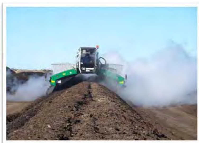
Figura 12 – Compostagem através do sistema de leiras revolvidas ( windrow ).
