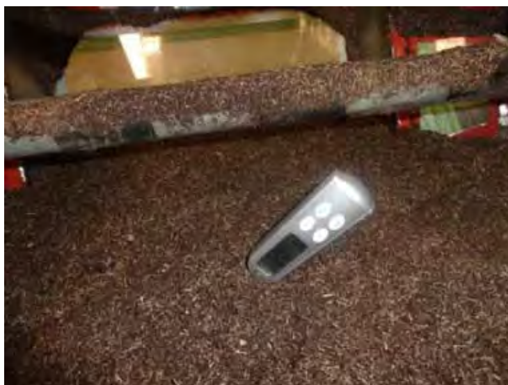
Figura 66 – Verificação da temperatura do composto, através de termômetro digital.
