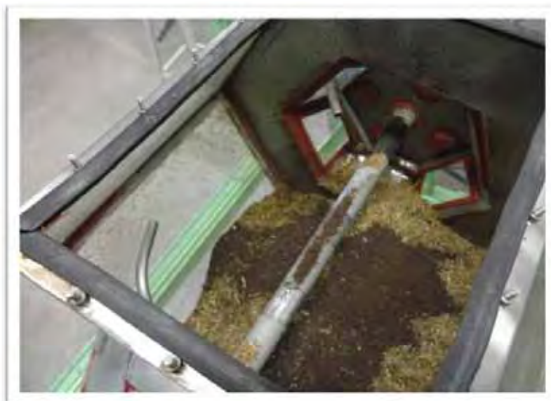
Figura 53 – Mistura dos resíduos de lodo de esgoto e de poda de grama, no interior do reator, para o início do processo de compostagem.
