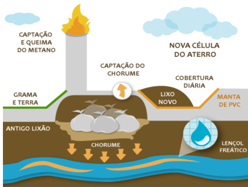
Figura 3 - Esquema da disposição dos resíduos sólidos em forma de aterro controlado.
