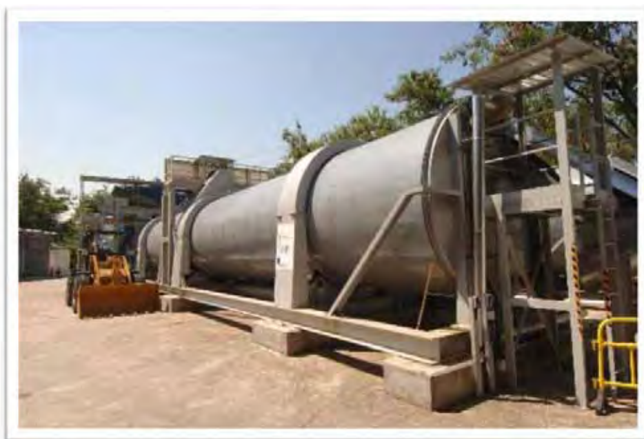
Figura 14 – Compostagem através do sistemas fechados ou reatores biológicos ( in-vessel ).
