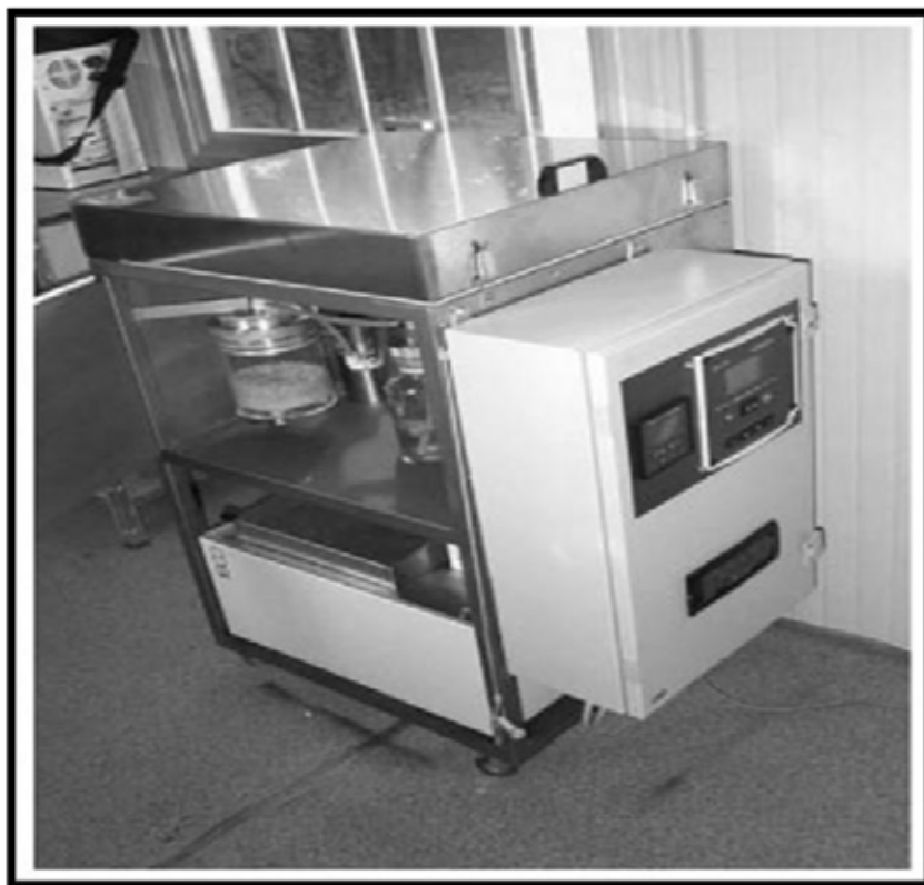
Figura 19 – Respirômetro AIR NL desenvolvido pelo LISA- Università di Trento .
