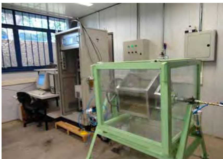
Figura 54 – Sistema de co-compostagem de lodo de esgoto e poda de grama, analisados pelo método respirométrico.
