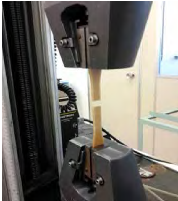
Figura 38 – Teste de tração em corpos de prova com 30%FM.
