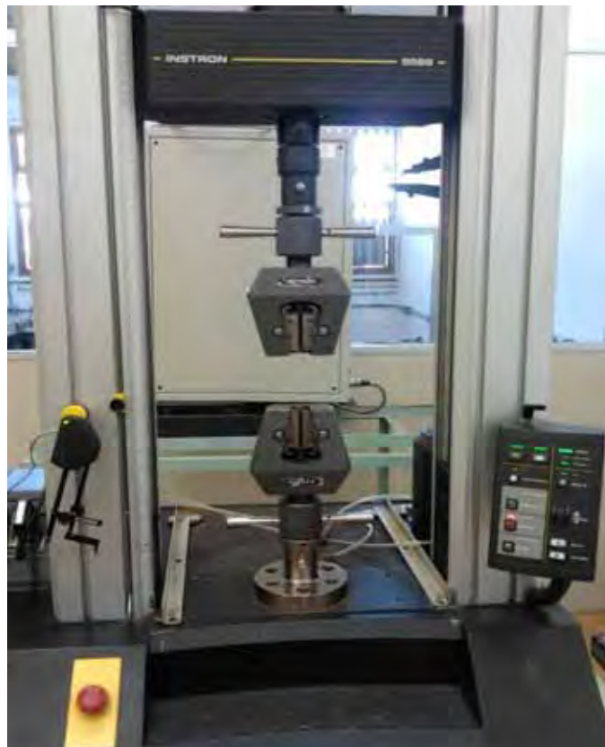
Figura 25 – Equipamento utilizado para o ensaio de tração.
