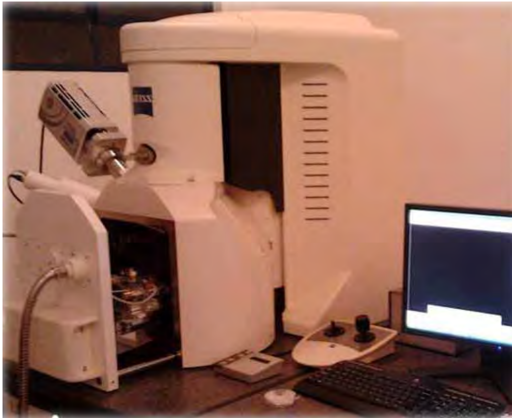
Figura 31 – Vista parcial do microscópio eletrônico de varredura.
