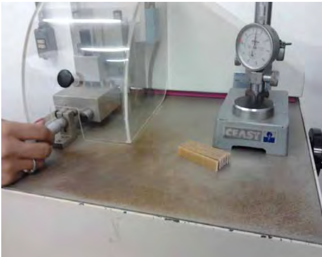
Figura 28 – Vista parcial da entalhadora usada para entalhar os corpos de prova conforme a ASTM D-256-00.
