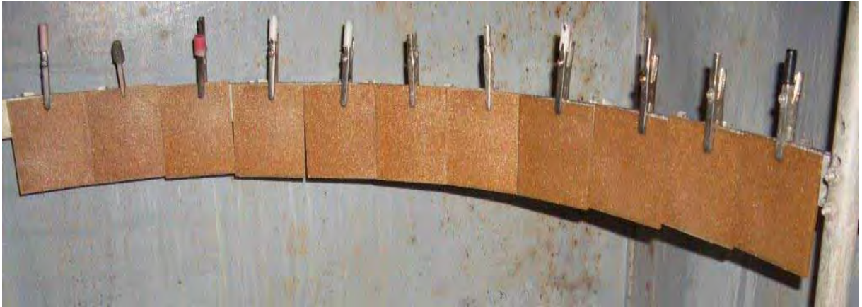
Figura 32 – Vista parcial das amostras do wpc no equipamento de ensaio de envelhecimento.
