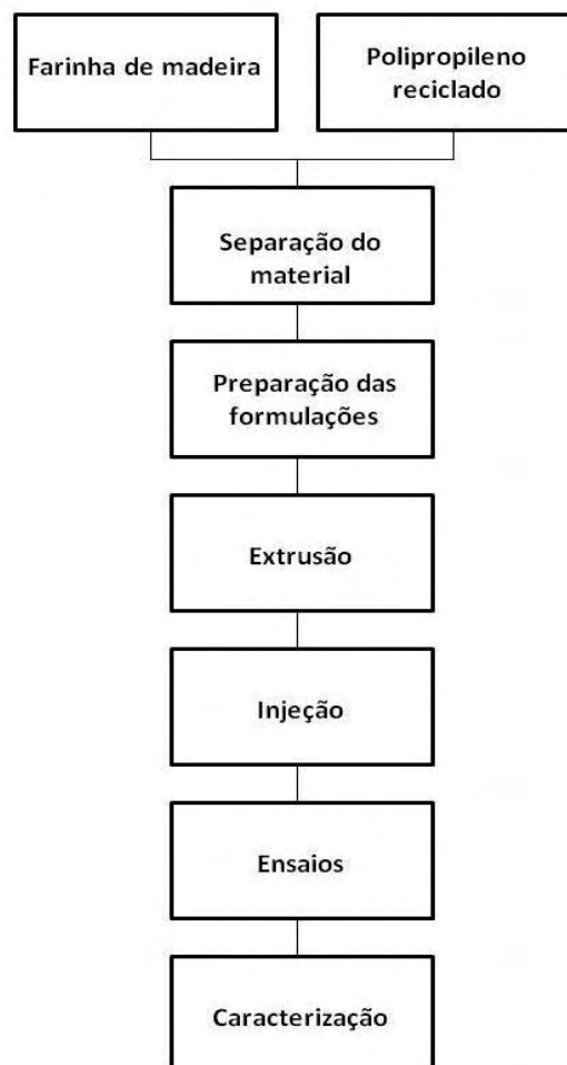
Figura 16 – Fluxograma das principais atividades desenvolvidas para o compósito plástico-madeira.
