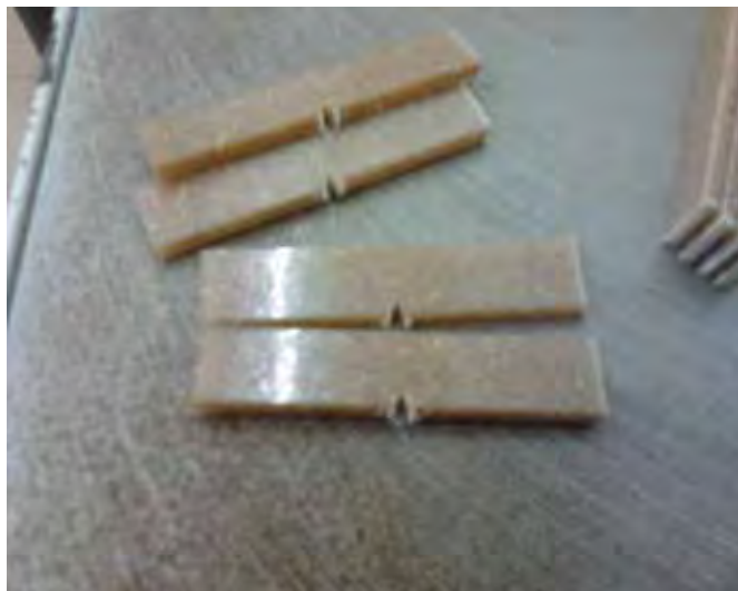
Figura 41 – Corpos de prova utilizados no ensaio de impacto.
