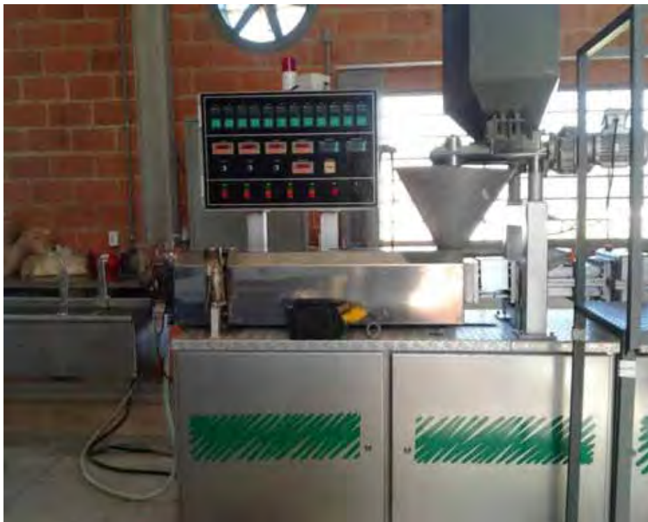
Figura 17 – Vista parcial da extrusora utilizada para a produção do compósito.
