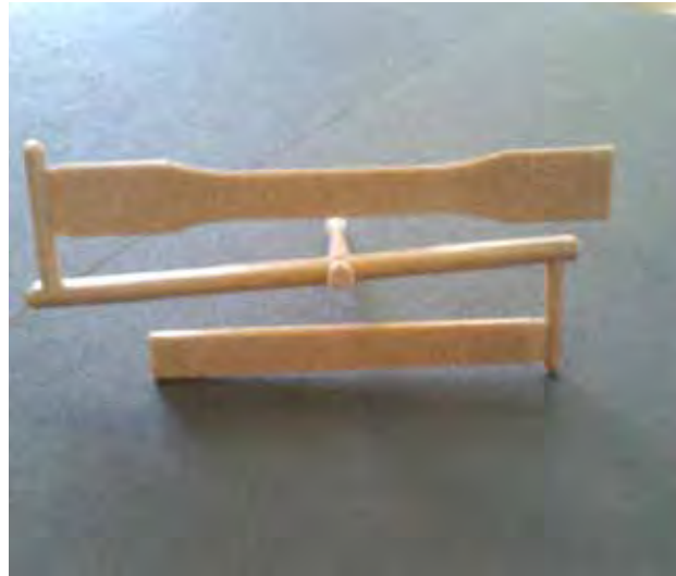
Figura 20 – Conjunto de corpos de prova para teste de impacto e para teste de tração.
