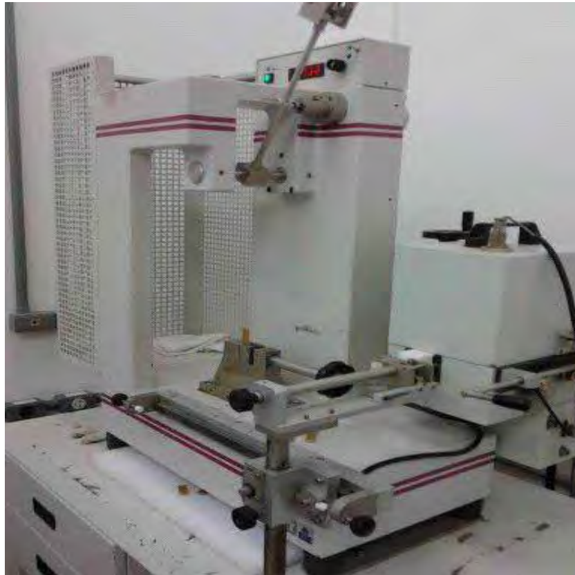
Figura 42 – Equipamento utilizado para o ensaio de impacto.
