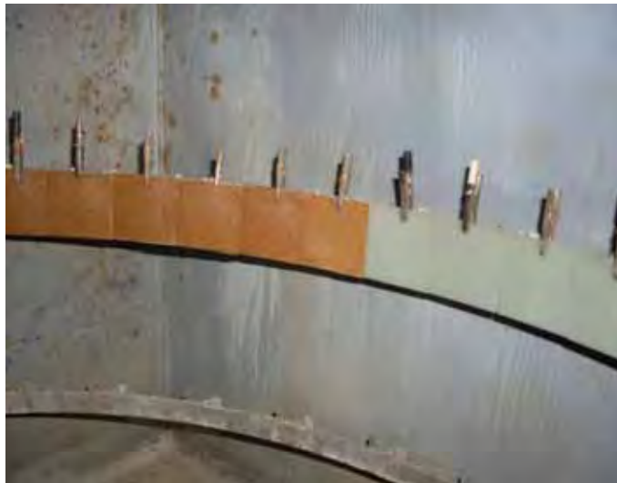
Figura 52 – Vista parcial das amostras do compósito e de 100%PP, no equipamento de envelhecimento artificial.
