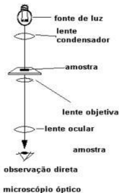
Figura 30 – Desenho esquemático de microscópio óptico. Fonte: adaptado de Dedavid et al. , 2007.
