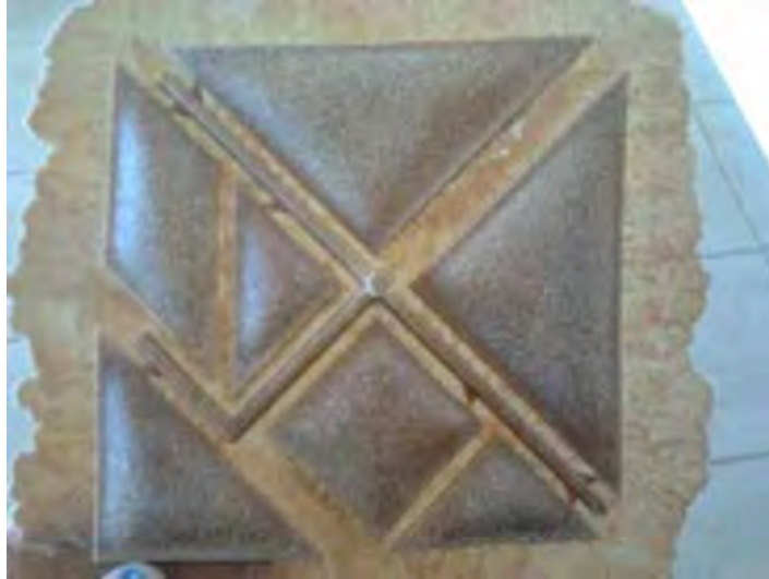
Figura 57 – Vista do produto com rebarbas provenientes de problemas na injeção.
