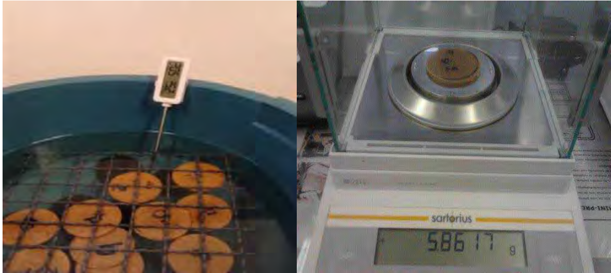
Figura 35 – Corpos de prova imersos em água destilada e corpos de prova sendo pesados.
