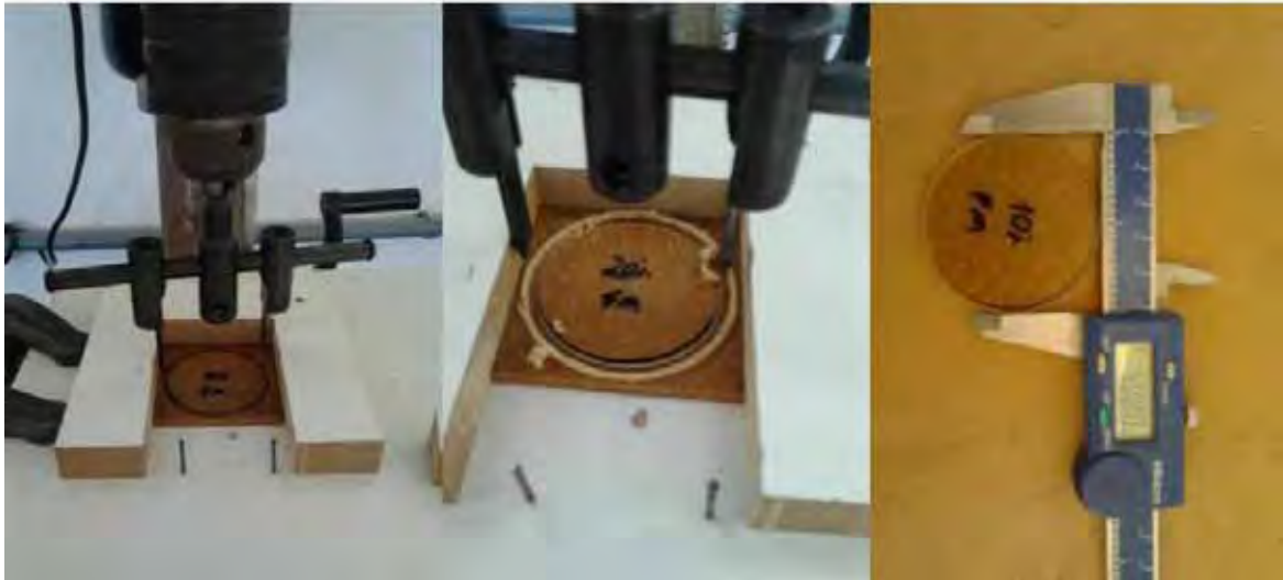
Figura 34 – Processo feito para cortar os corpos de prova.
