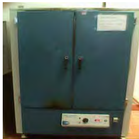
Figura 15 – Estufa usada na secagem do material.
