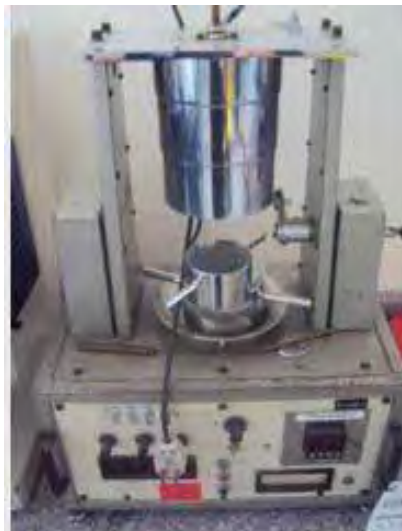
Figura 29 – Exemplo do plastômetro utilizado no ensaio de índice de fluidez.
