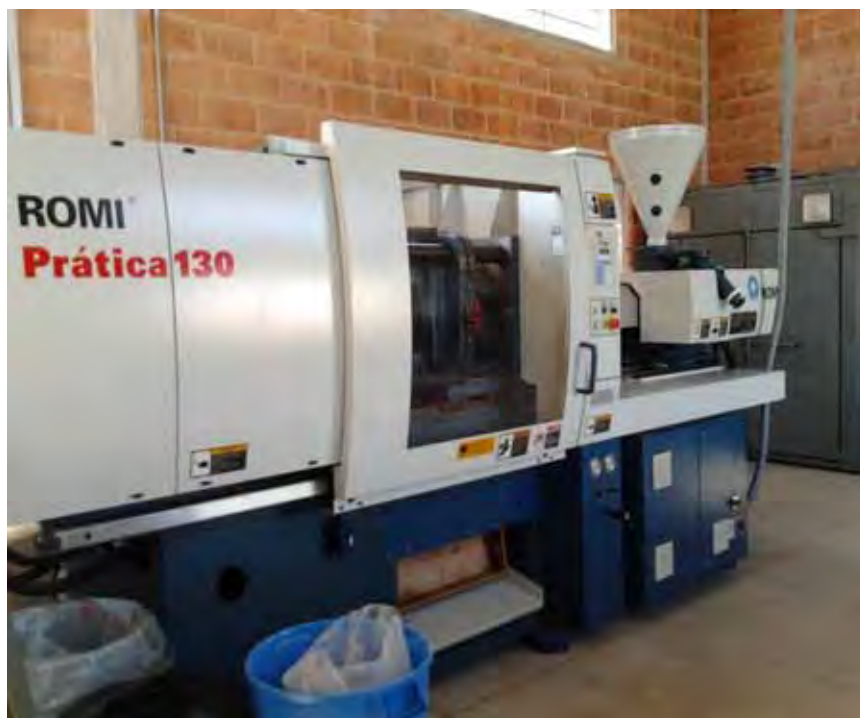
Figura 19 – Máquina Injetora utilizada para a produção do compósito.
