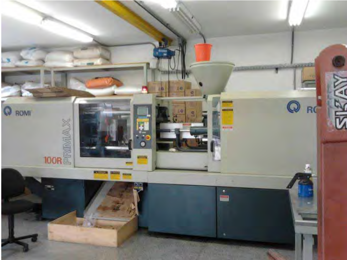
Figura 55 – Vista parcial da injetora utilizada na produção do Tangram.
