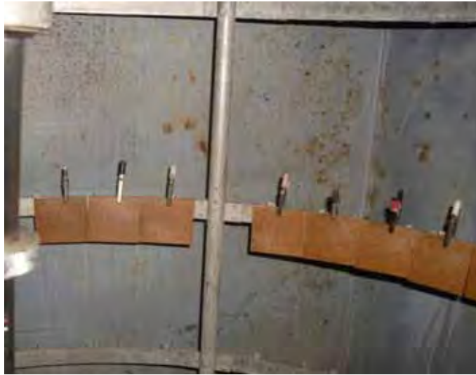
Figura 51 – Vista parcial das amostras do compósito no equipamento de envelhecimento artificial.
