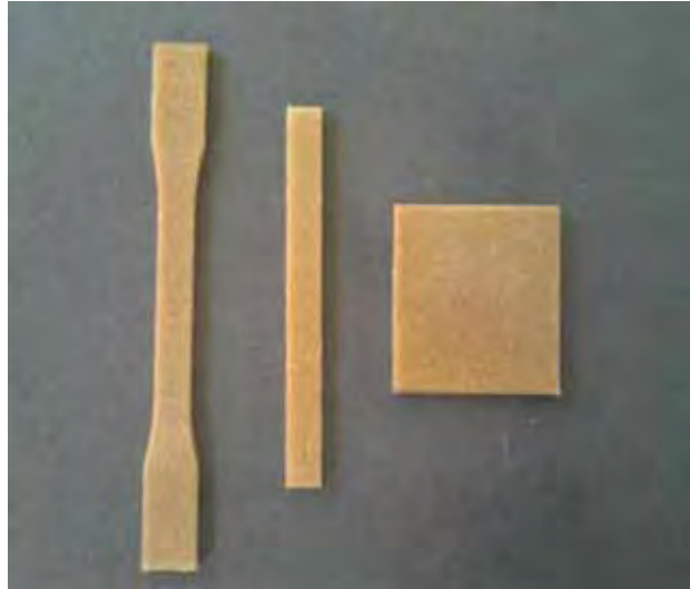
Figura 22 – Corpos de prova separados individualmente.
