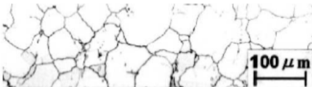
Figura 9: Microestrutura típica da liga NIMONIC 80A Fonte: Adaptado de Kim et al (2001)
