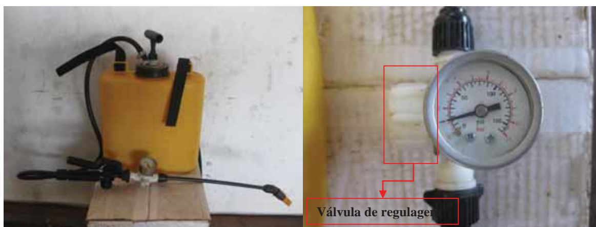
Figura 4. Pulverizador lateral com estabilizador de pressão. Presidente Prudente -SP – APTA – Alta Sorocabana 2010.
