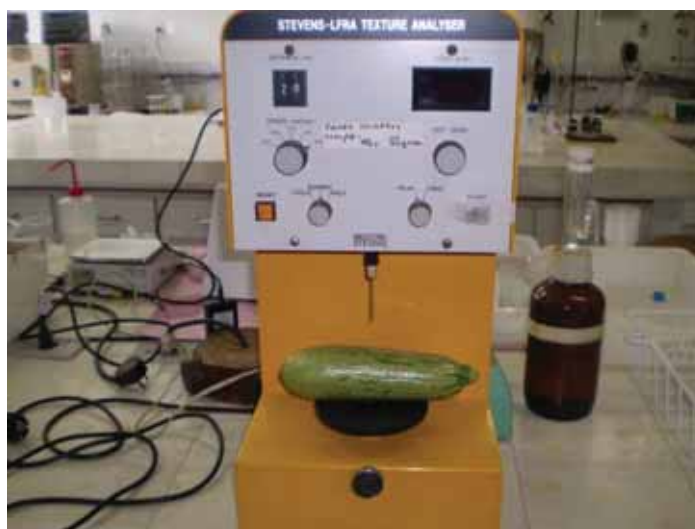
Figura 7. Texturômetro utilizado e fruto sendo preparado para a análise. FCA/UNESP, 2010.
