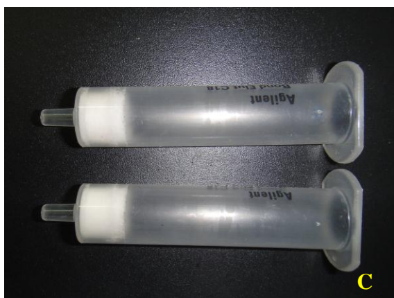
Figura 1. Determinação de antocianina. A – Ativação de cartuchos. B – Retenção dos pigmentos no cartucho. C – Cartuchos SEP-PAK 18. D – eppendorfes com amostras para centrifugar.
