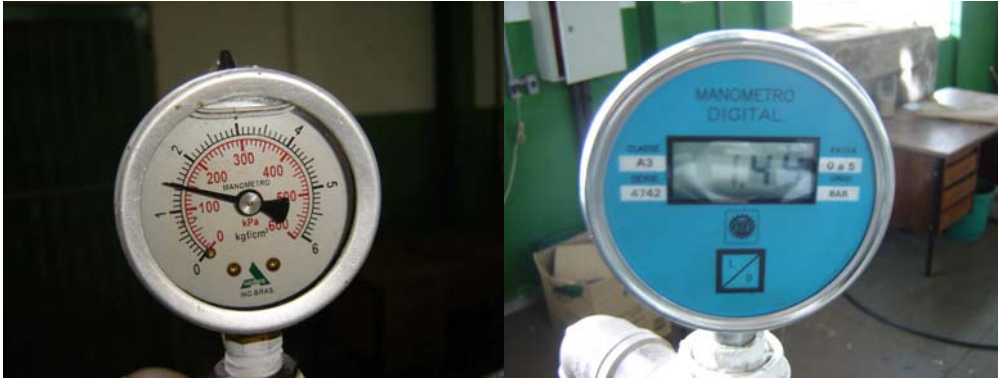
Figura 4 – Vista geral dos manômetros (analógico e digital).
