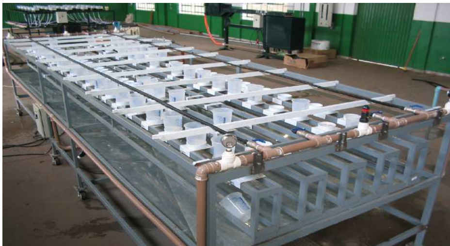
Figura 2 – Vista geral da bancada de ensaios para tubo gotejadores.
