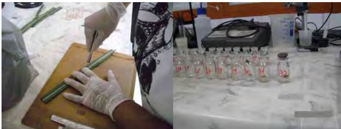
Figura 4. Extração dos discos foliares de cana-de-açúcar e recipientes para extração da clorofila com ácido.
