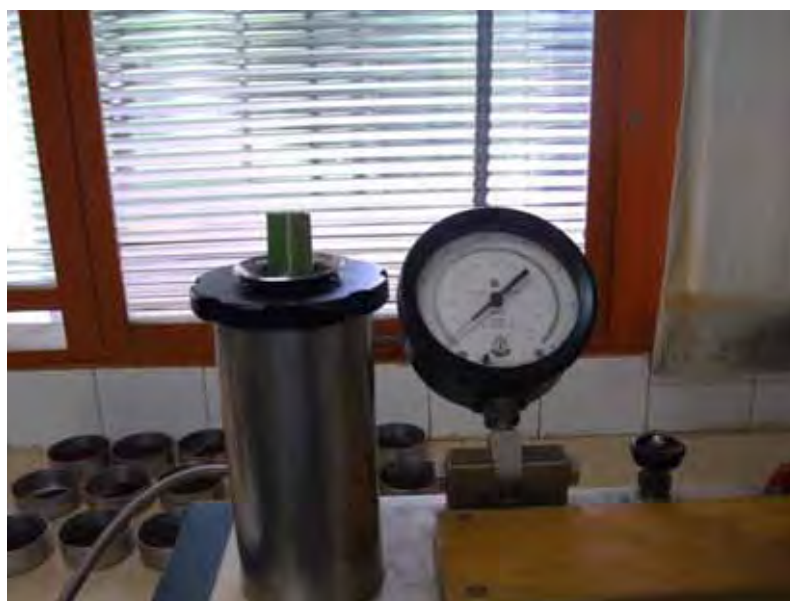
Figura 5. Medida do potencial hídrico em folha de cana-de-açúcar com uma câmara de pressão.
