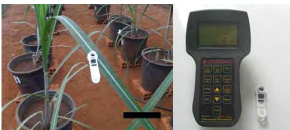
Figura 2. Presilha para adaptação da folha ao escuro e fluorômetro
